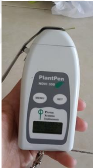
Şekil 3.16. PlantPen NDVI 300 cihazı ile klorofi yoğunluğu deęeri ölçülmesi
