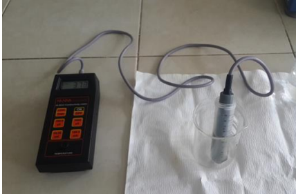
Şekil 3.14. Elektrolit sızıntısı ölçüm aşamalarında, çalkalayıcıda inkübe edildikten sonra çıkarılan zeytin yaprak örneğinin EC1 okumasının yapılması
