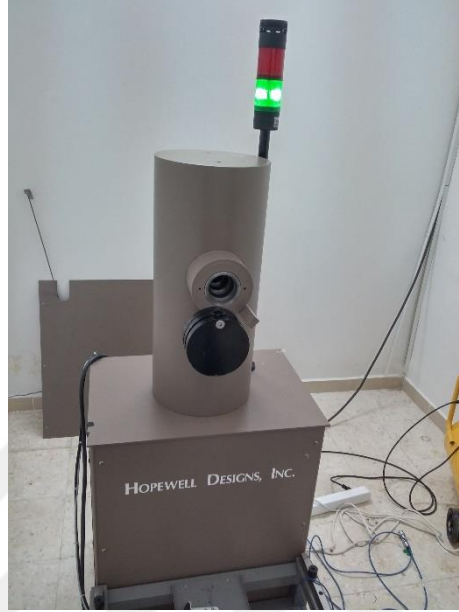
řekil 3.34. ^{137}\text{Cs} gama radyasyon kaynađının yer aldıđı ıřınlama cihazı
