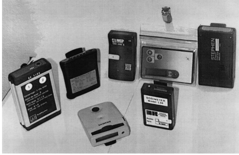
Şekil 1.14. Elektronik dozimetreler. (Arka sıra soldan sağa doğru: Doxi-2G, Rad 50s, DMC 2000S, DOSIMAN, STEPHEN 6000. Ön sıra soldan sağa doğru: EPD ve L36) (Texier vd., 2001)
