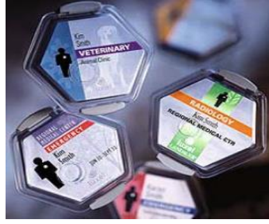
Şekil 1.13. Farklı uygulama alanları için tasarlanmış OSL dozimetre örnekleri (TAEK, 2012)
