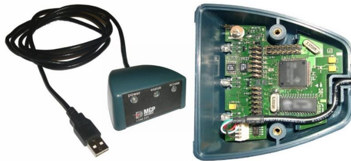
Şekil 3.7. LDM 220 dozimetre okuyucunun önden görünüşü (sol) ve iç görünüşü (sağ) (MGP, 2006)
