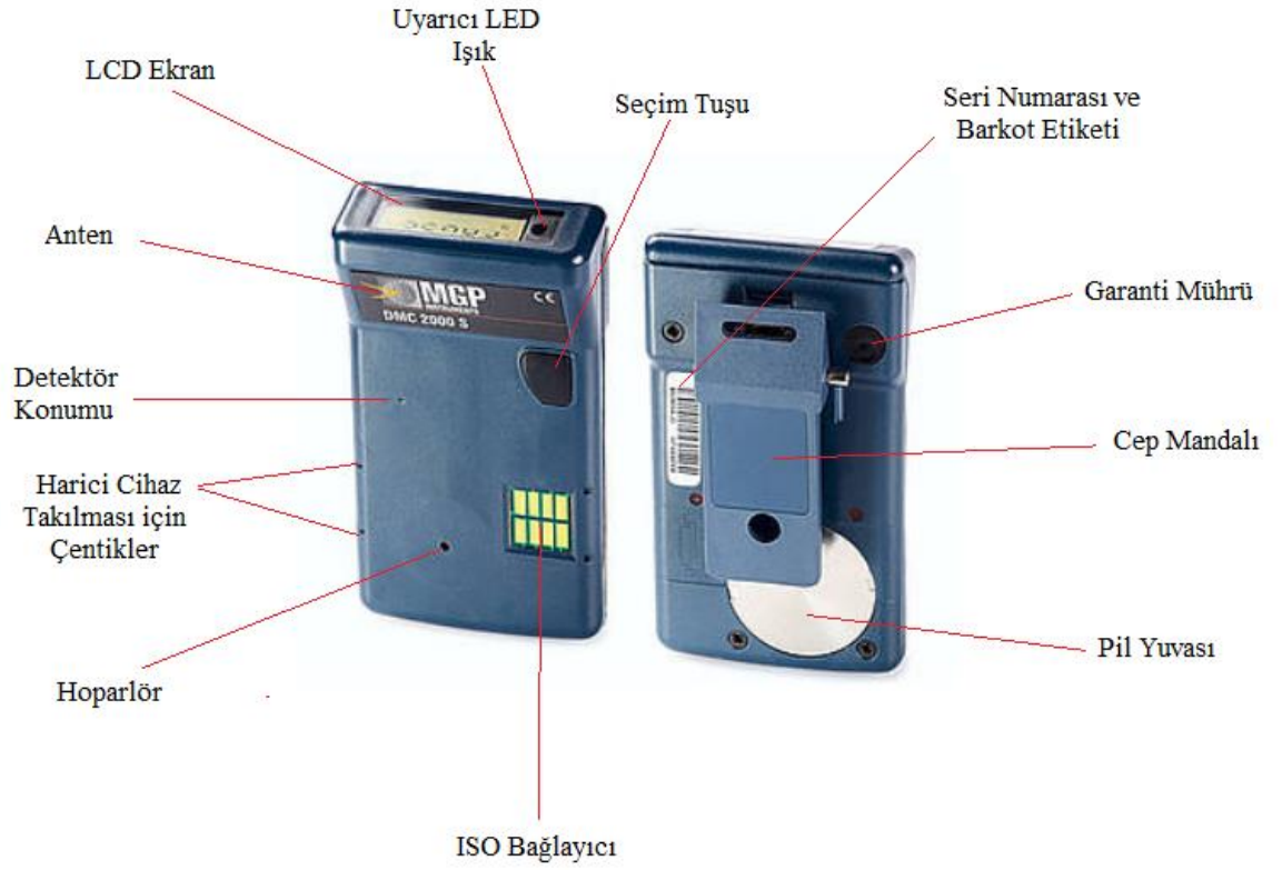
Şekil 3.1. DMC 2000S elektronik dozimetre bileşenleri (MGP, 2006)
