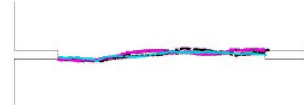
Şekil 2.11. Referans Numunelerde çatlak yörüngeleri
