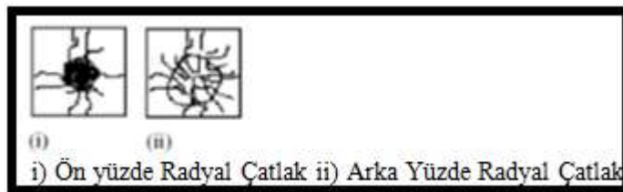
Şekil 2.8. Radyal çatlak hasar formları [14]
