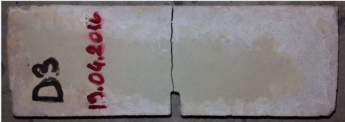
Resim 9.35. 0,75 cm çentikli 2x5x15 cm 3 'lük D3 kodlu numunenin kırılmış görüntüsü
