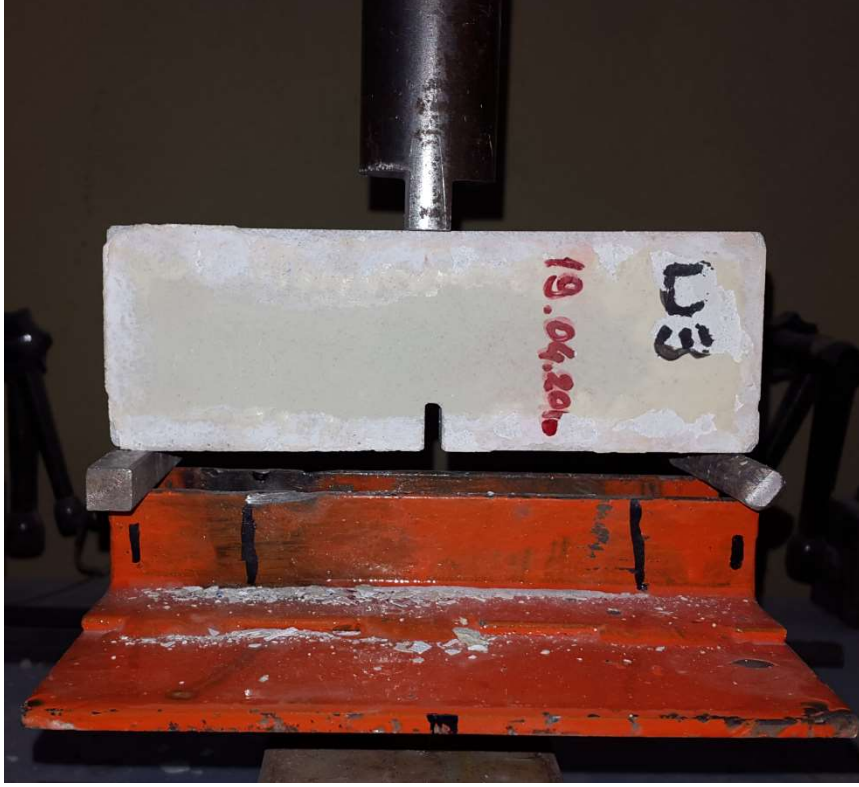
Resim 9.34. 2x5x15 cm 3 'lük numunelerin örnek üç noktalı eğilme deneyi görüntüsü
