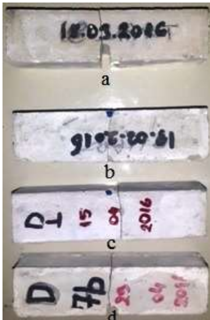
Resim 9.33. 2,5x2,5x10 cm 3 'lük kiriş numunelere ait kırılma sonrası görüntüsü
