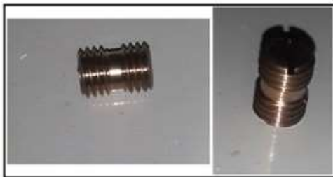
Resim 8.1. Pirinç vidanın yatay ve düşey görünümü
