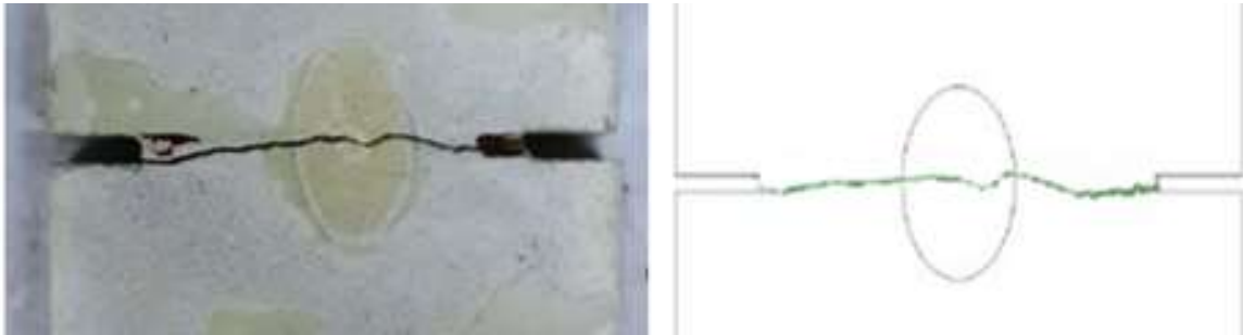
Resim 9.20. K1-1,7c numunesine ait kırılma sonrası görüntüsü ve çatlak yörüngesi
