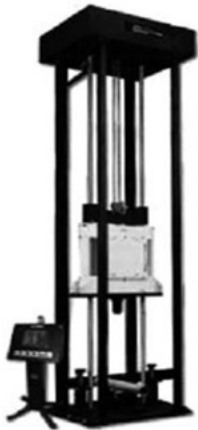
Resim 2.2. Ağırlık-Düşürme çarpma deney makinesi [6]
