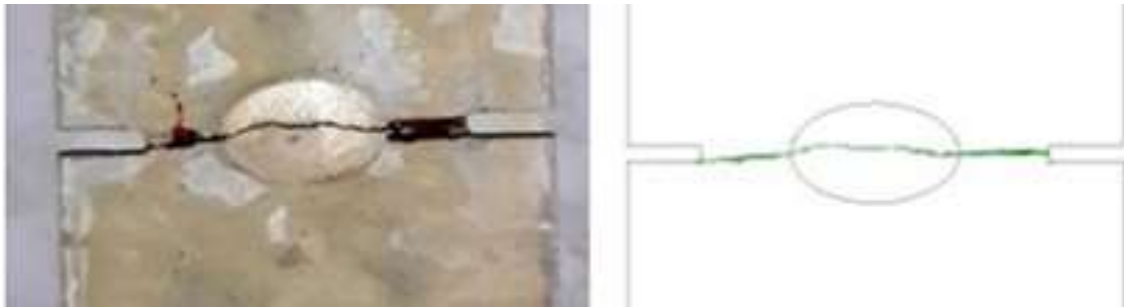
Resim 9.14. K1-1,7a numunesine ait kırılma sonrası görüntüsü ve çatlak yörüngesi
