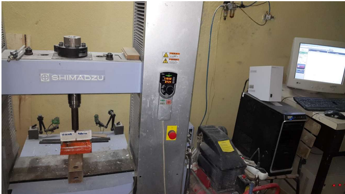
Resim 8.8. Eğilme deneylerinde kullanılan test cihazı
