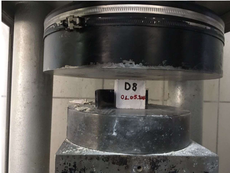
Resim 8.9. Standart küp basınç deneyi
