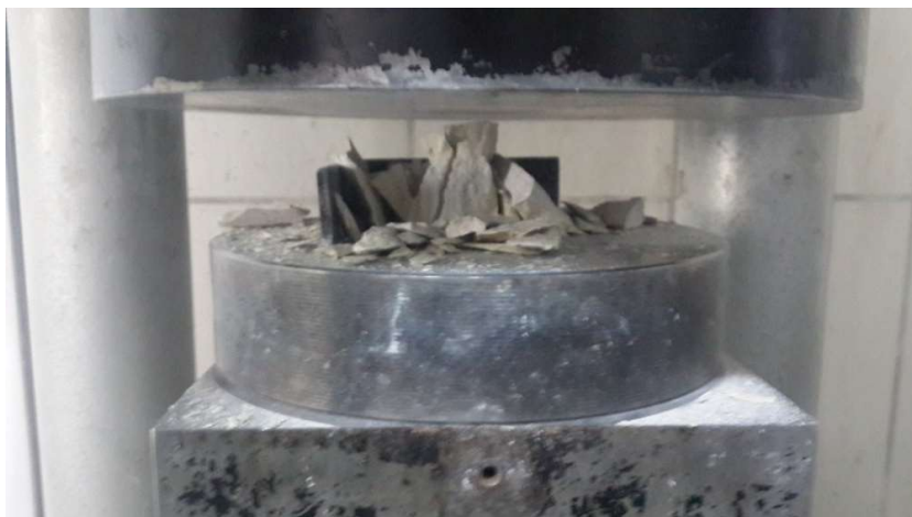
Resim 8.10. Basınç deneyi sonrası beton küp numune
