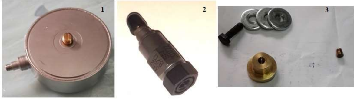
Resim 8.2. 1-PCB dinamik yük-ölçer, 2- PCB ivme-ölçer, 3- İvme-ölçer adaptörleri
