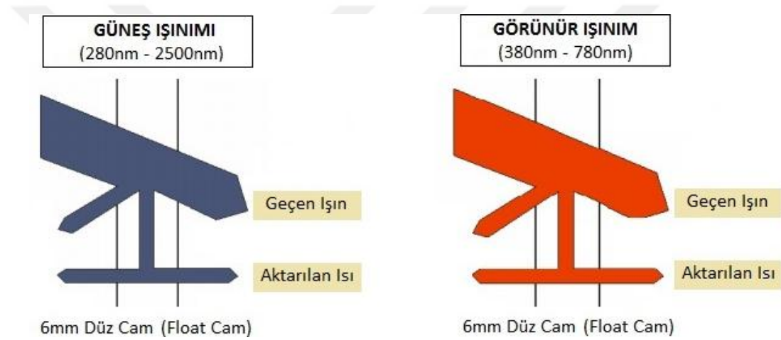
Şekil 2.11 Güneş ışınımının düz camdan geçişi [25]
