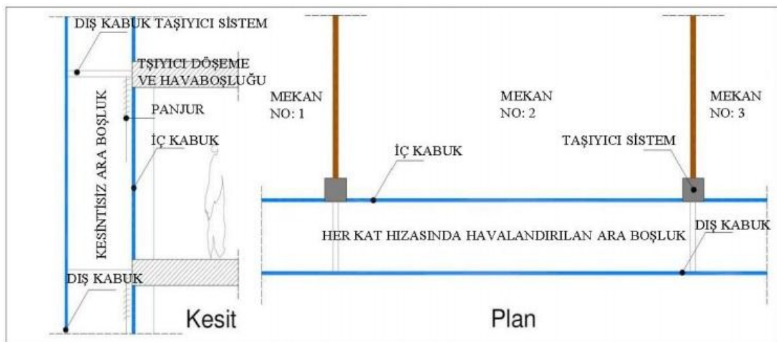
Şekil 3.11 Cephe yüksekliğinde çift kabuklu cephe [32]
