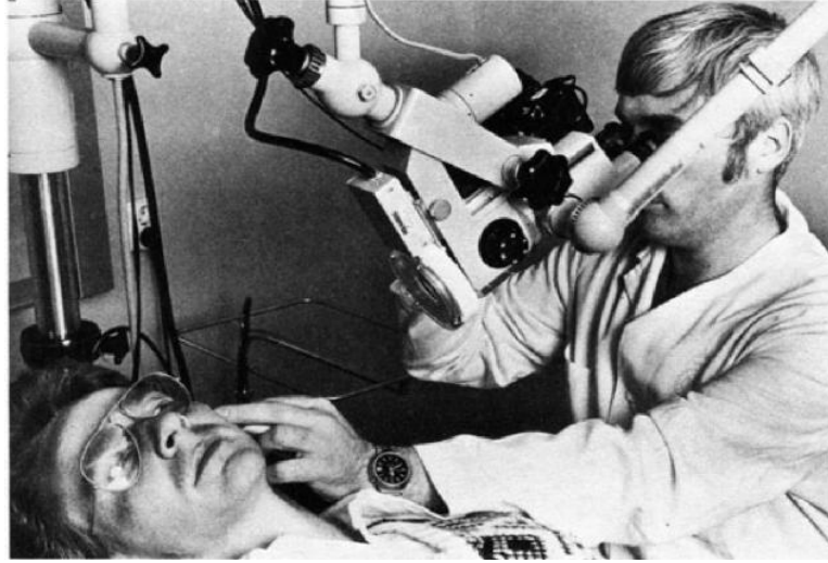
Resim 3.14: Orta Eksenli Ring-Flaş Kaynağı Eklenmiş Ameliyat Mikroskoku.
