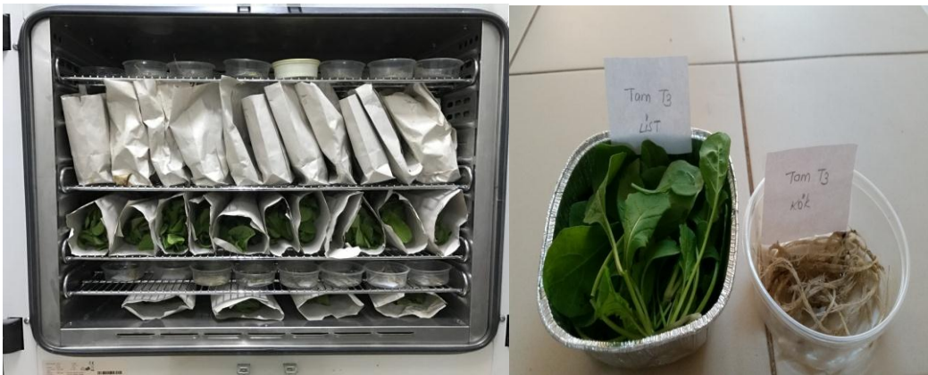
Şekil 3.17. Yaş ve kuru ağırlıkları hesaplamaları için etüvde kurutulan roka bitkileri
