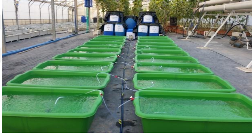
Şekil 3.8. Besin solüsyonu doldurulmuş yetiştirme teknelerinin ve havalandırma sisteminin genel görünüşü
