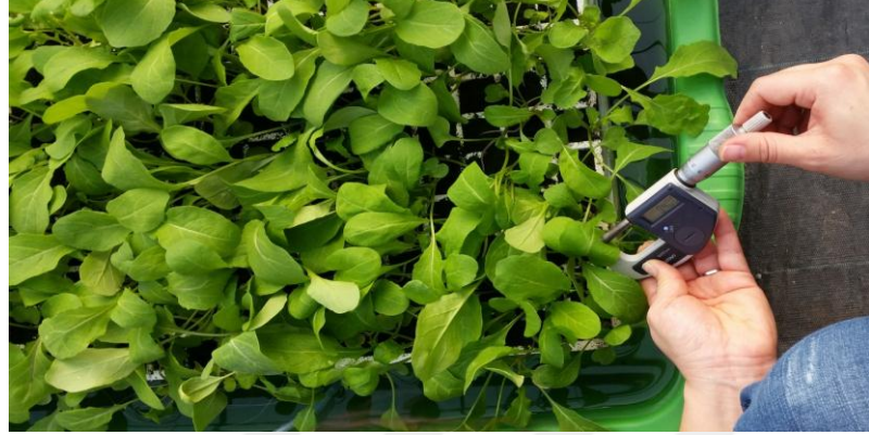
Şekil 3.13. Roka bitkisinde mikrometre ile yaprak kalınlık ölçümü
