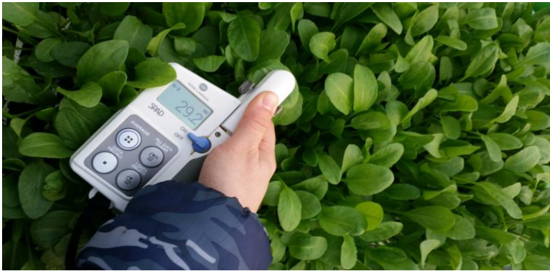
Şekil 3.21. Kuzukulağı bitkisinde klorofil metre ile yaprak klorofil içeriğinin belirlenmesi
