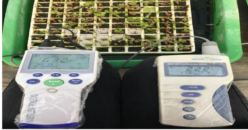
Şekil 3.23. EC ve pH ölçümü ve kullanılan metreler
