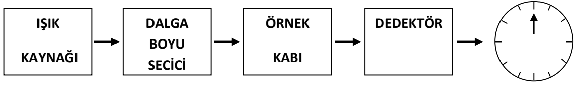
Şekil 1.5. Bir spektrofotometrenin temel bileşenleri
