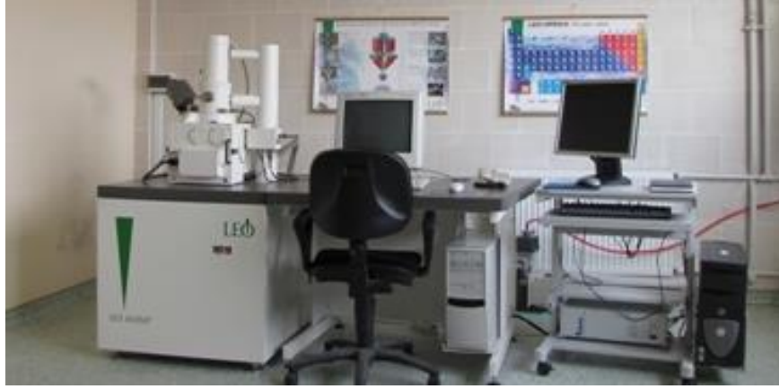
Şekil 3.9. Taramalı elektron mikroskobu (SEM) görünümü
