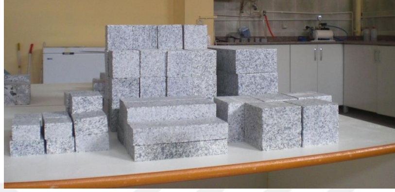
Şekil 3.3. Fiziko-mekanik deneyler için farklı ebatlarda hazırlanan Hisar Gri numunelerinin görünümü
