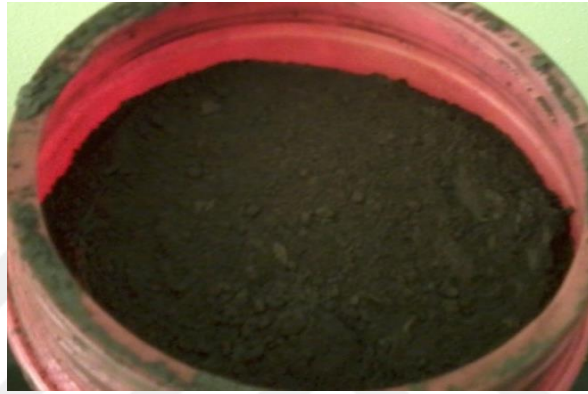
Şekil 3.5. Elmas soket matriksinde kullanılan bor karbürün görünümü
