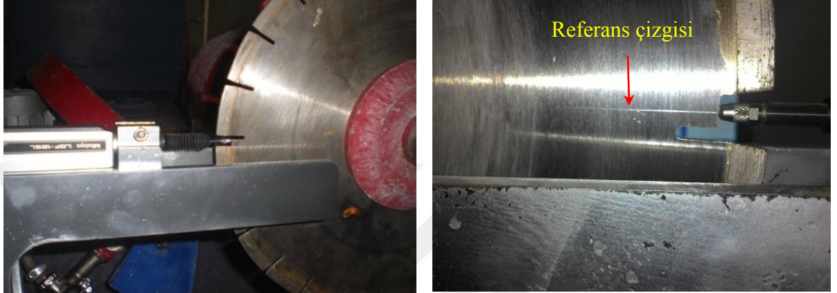
Şekil 3.21. Doğrusal ölçüm cihazı için testere üzerinde açılan referans noktası
