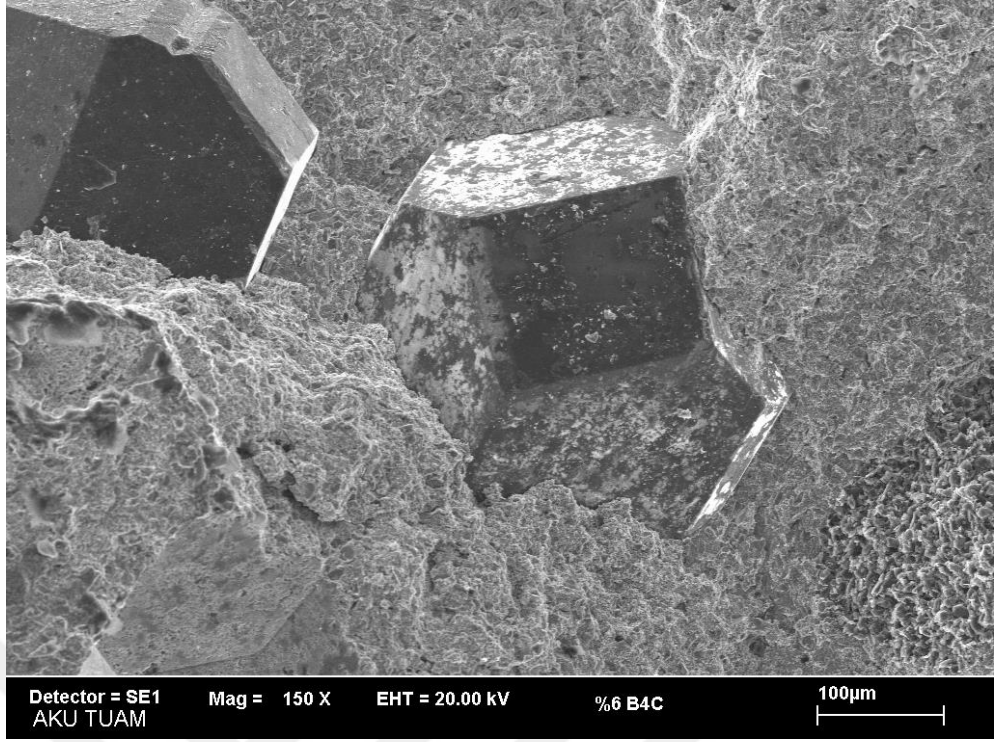
Şekil 4.24. % 6 B 4 C katkılı socketin 150 kat büyütülmüş kırılma yüzeyi SEM görüntüsü
