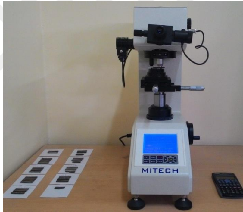
Şekil 3.7. Mikro sertlik ölçme cihazı
