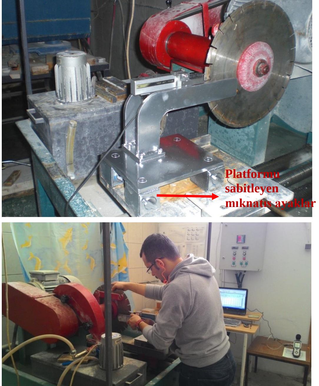
Şekil 3.23. Aşınma ölçüm sistemi ve ölçüm anından genel görünümü
