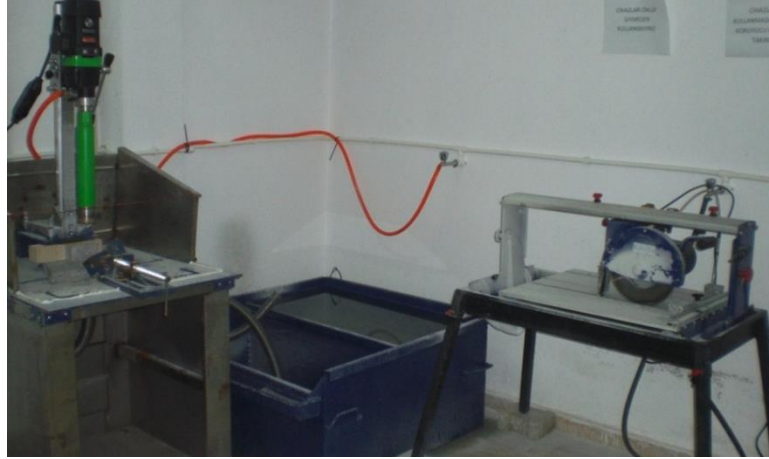
Şekil 3.4. Numune boyutlandırma diski ve karot makinesinin görünümü
