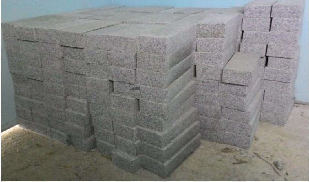
Şekil 3.1. Hisar Gri numunelerinin 5x10x25 cm boyutlarındaki görünümü
