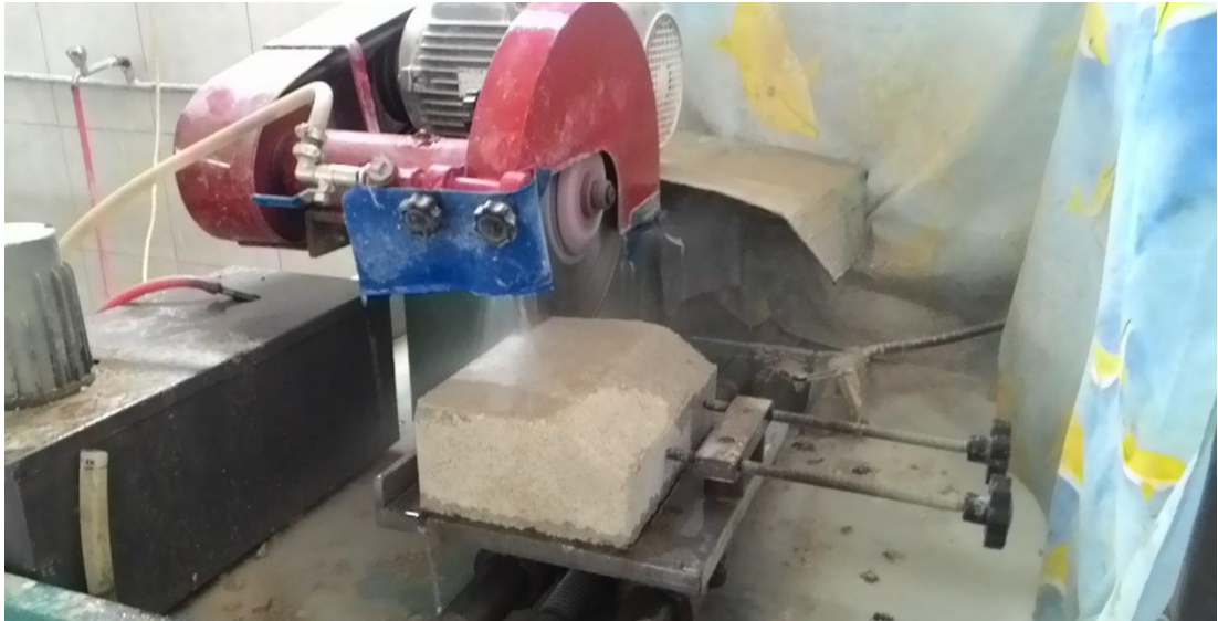
Şekil 3.18. Kesme deneyi öncesinde beton blok ile testere bilenmesinden görünüm
