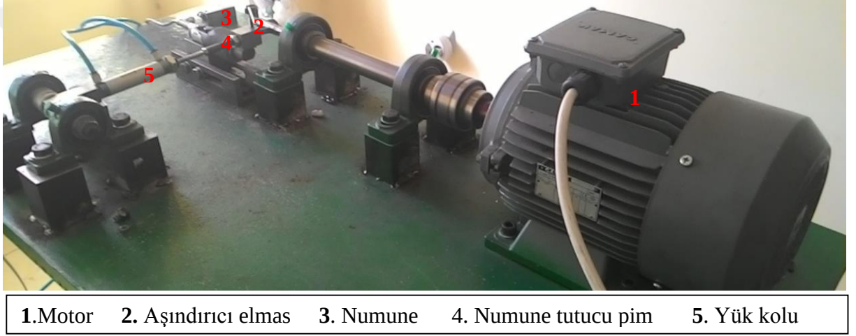
Şekil 3.8. Aşınma deney setinin genel görünümü
