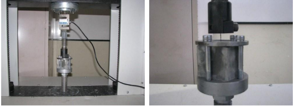
Şekil 2.14. SIFCON pull - out deneyi (Tuyan ve Yazıcı 2012)
