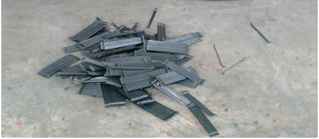
Şekil 3.1. Deneylerde kullanılan çelik lifler.
