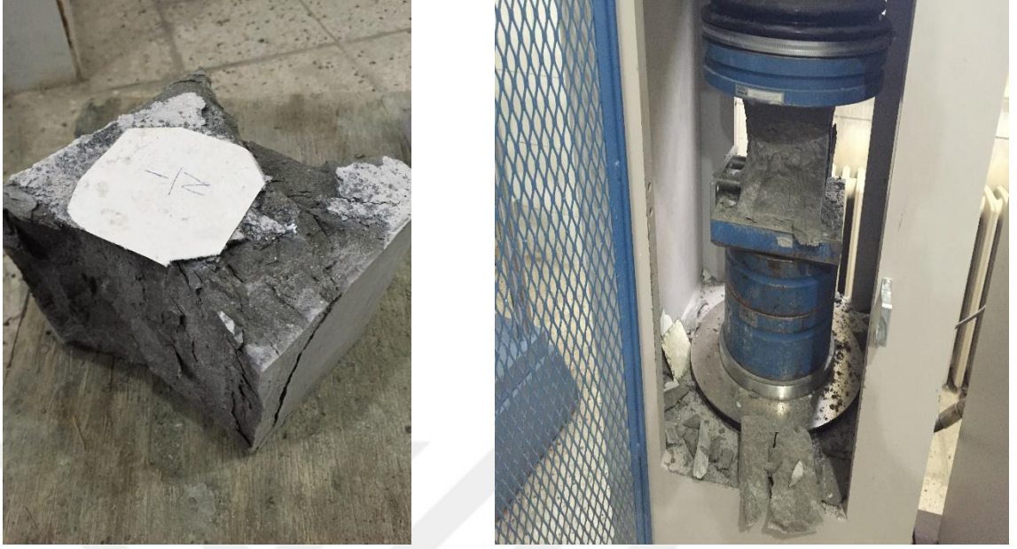
Şekil 4.3. Lifsiz SIFCON numunesinin basınç dayanım testi sonucu kırılma şekli
