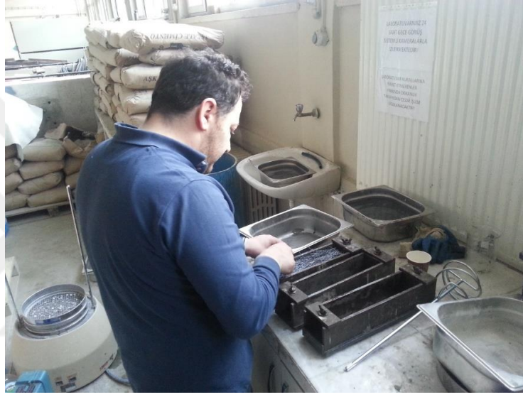
Şekil 3.5. Çelik liflerin önceden kalıba yerleştirilmesi
