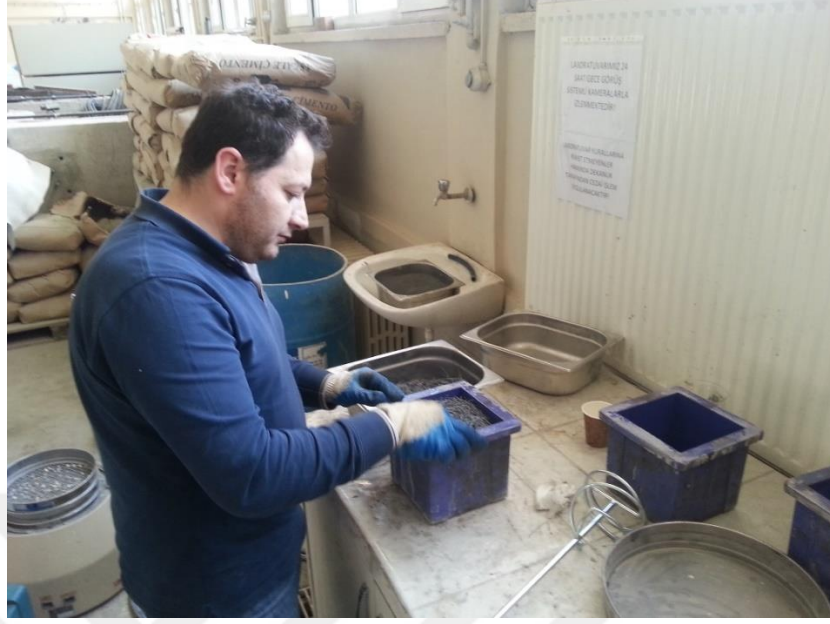
Şekil 1.1. Çelik liflerin önceden kalıba el ile yerleştirilmesi
