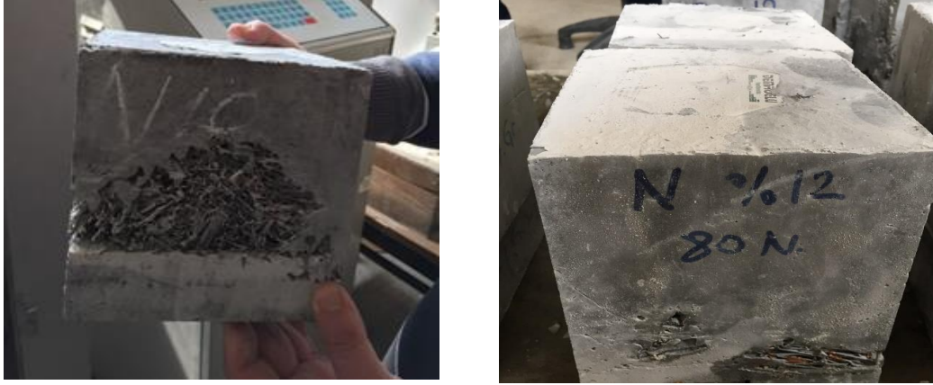
Şekil 4.2. SIFCON matrisinin %12 lif içeriğinde lif ağına tam olarak emdirilememesi örneği (Lif yoğunluğu şekilde açıkça görülmektedir)
