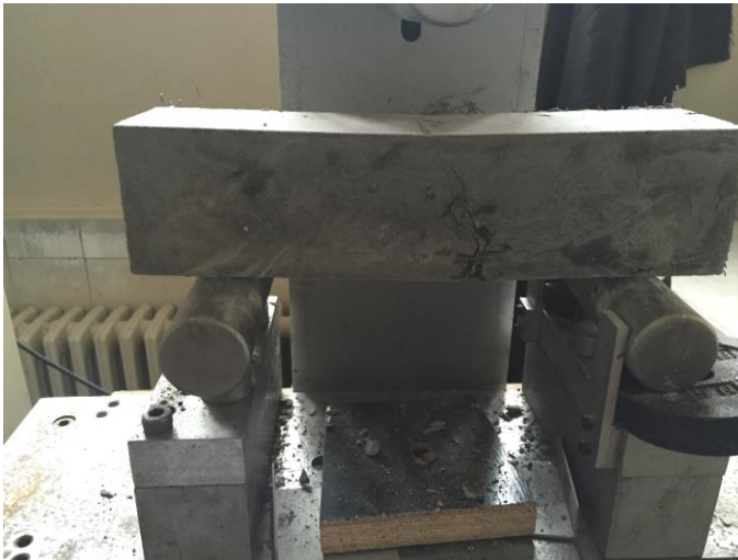
Şekil 4.8. Lifli SIFCON numunesi eğilme deneyi sonucu kırılma şekli
