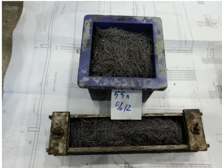
Şekil 3.6. Kalıba yerleştirilmiş çelik lifler
