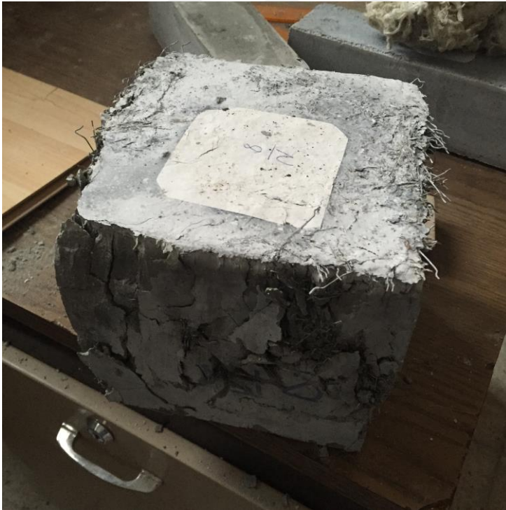
Şekil 4.4. Lifli SIFCON numunesinin basınç dayanım testi sonucu kırılma şekli
