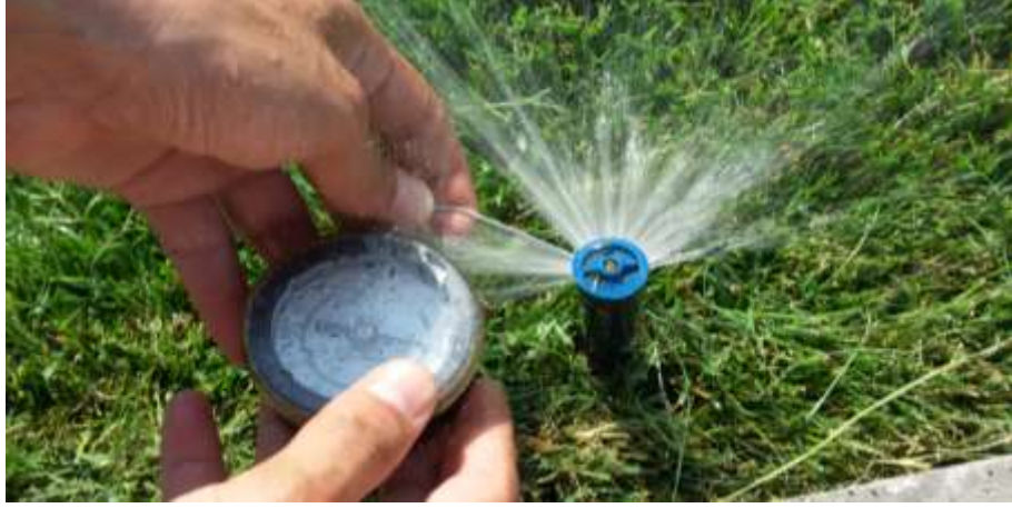
Şekil 3.6. Yağmurlama başlıklarının basınç ölçümleri
