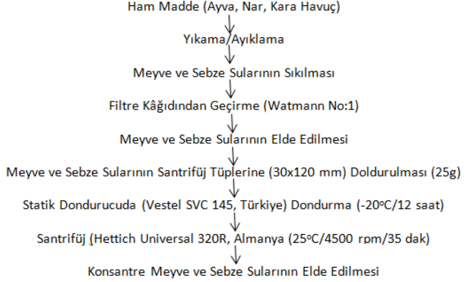
Şekil 3.1. Konsantre ayva, nar ve kara havuç sularının üretim akım şeması
