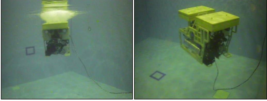
Şekil 4.9: UKSA havuz testinden sualtı görüntüleri.
