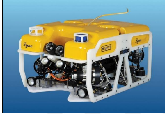
Őekil 1.2: Aık ereve form Őeklinde tasarlanmış sualtı aracı.
