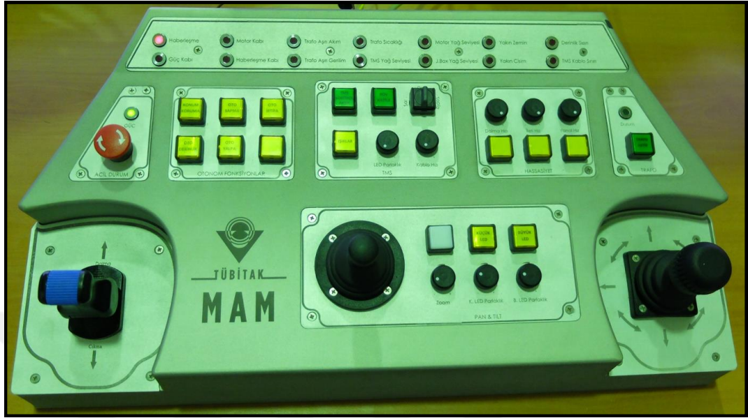
Şekil 2.30: Kumanda konsolu enerji verilmiş hali.
