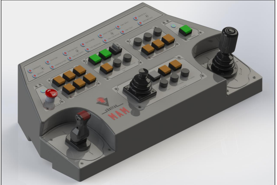
Şekil 2.22: Kumanda konsolu 3D katı modeli.
