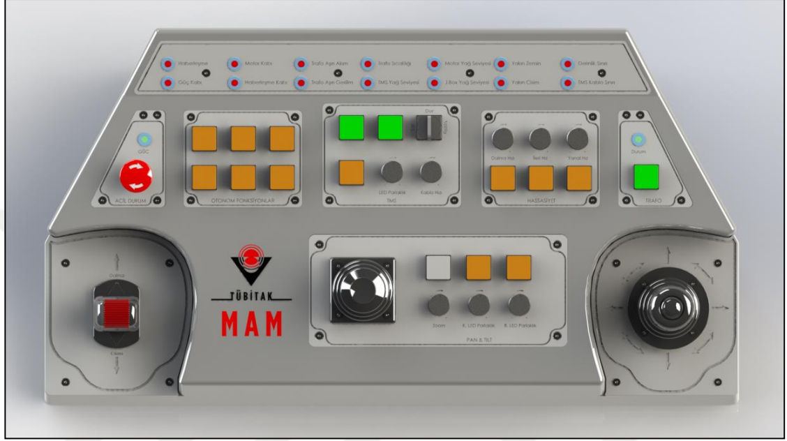
Şekil 2.19: Kumanda konsolu modeli.
