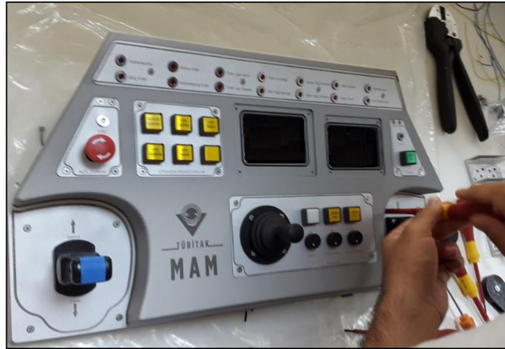
Şekil 2.25: Plakalar üzerindeki elemanların montajı.
