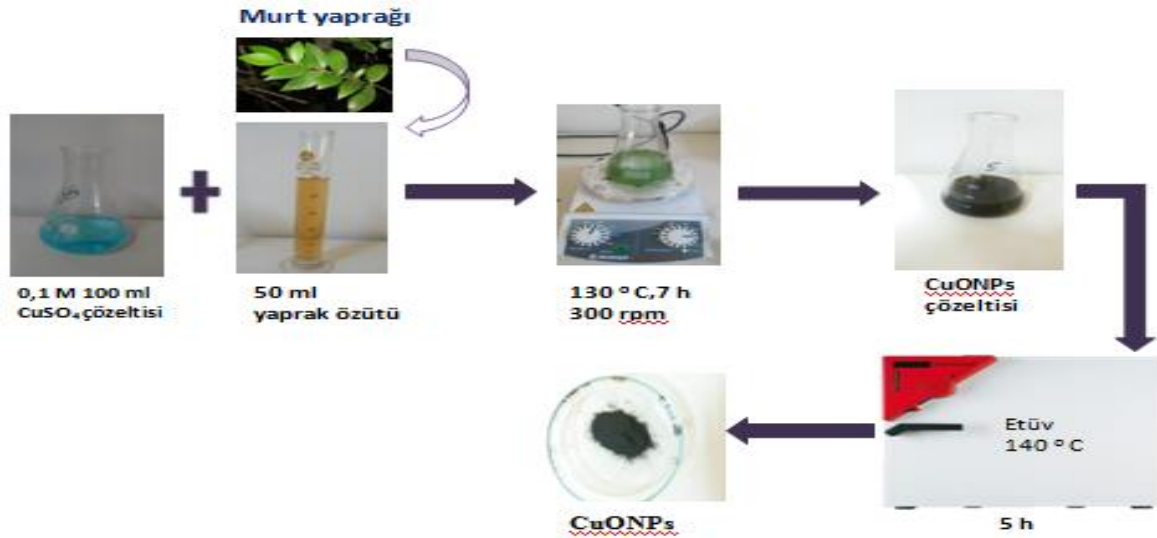
Şekil 3.1. CuONPs'in biyosentez yönteminin şematik gösterimi
