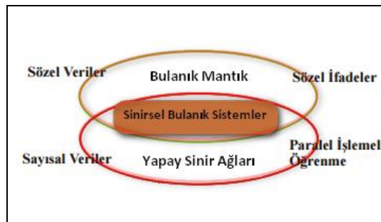
Şekil 4.8 Sinirsel bulanık sistemlerin sinir ağları ve bulanık mantıkla ilişkisi
