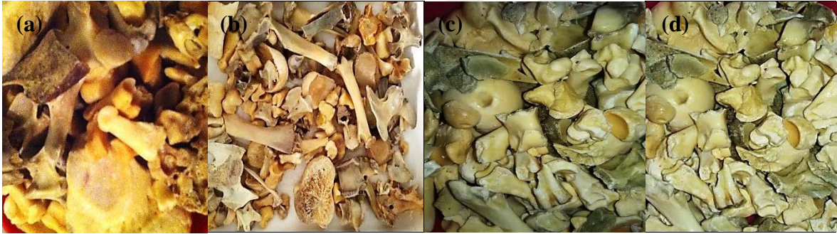
Şekil 4.1. a; basınçlı tencerede 2 saat kaynatılmış kemikler. Sırasıyla b, c, d; % 5 NaOH ilave edilen çözeltilerde 4 defa 30 dakika kaynatma işlemi yapılmış kemikler
