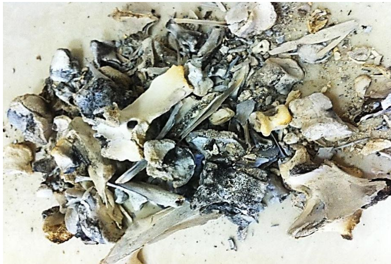
Şekil 4.2. 350 °C 'de 2 saat ön kalsine işlemi uygulanmış kemikler
