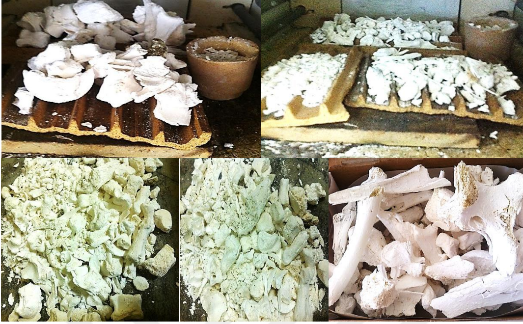
Şekil 4.3. 700 °C 'de 4 saat süre bekletilen kemikler
