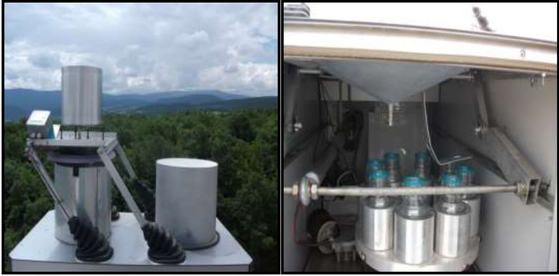
Şekil 3.6. Otomatik sıralı yağmur örnekleyicisi ve numune kapları
