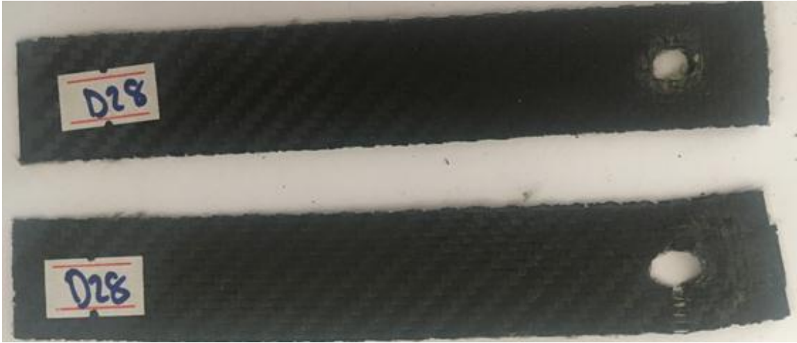
Şekil 3.101. G/C/C/G tek pim bağlantılı numunenin hasar görüntüsü.
