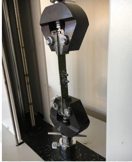
Şekil 3.61. H/A/A/H çift pim bağlantılı numunenin çekme deneyi.
