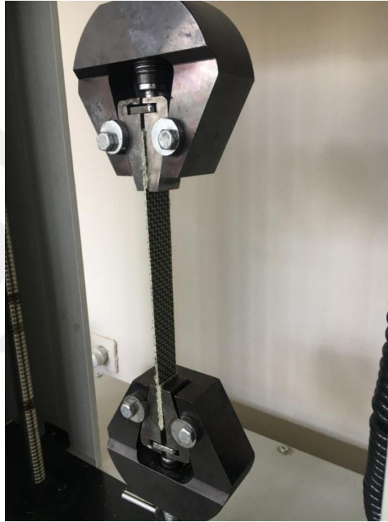
Şekil 3.56. H/A/A/H tabakalı deliksiz kompozit numunenin çekme deneyi.
