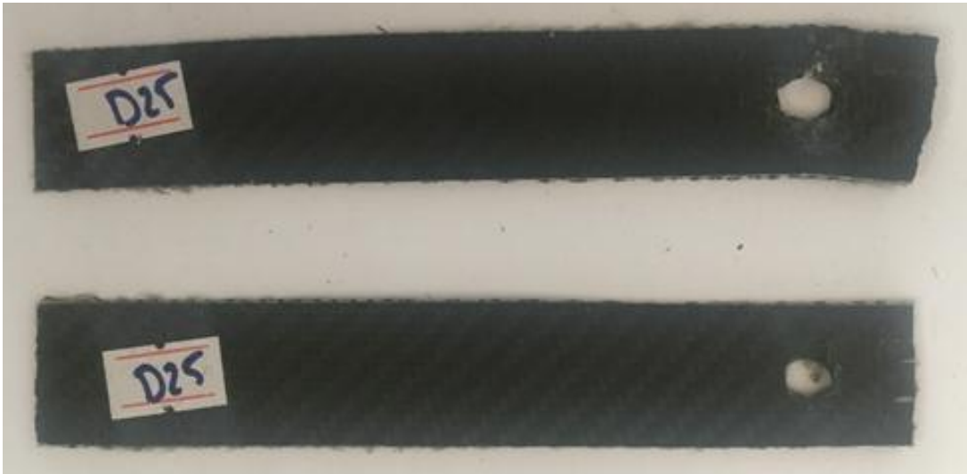
Şekil 3.91. G/G/C/C tek pim bağlantılı numunenin hasar görüntüsü.
