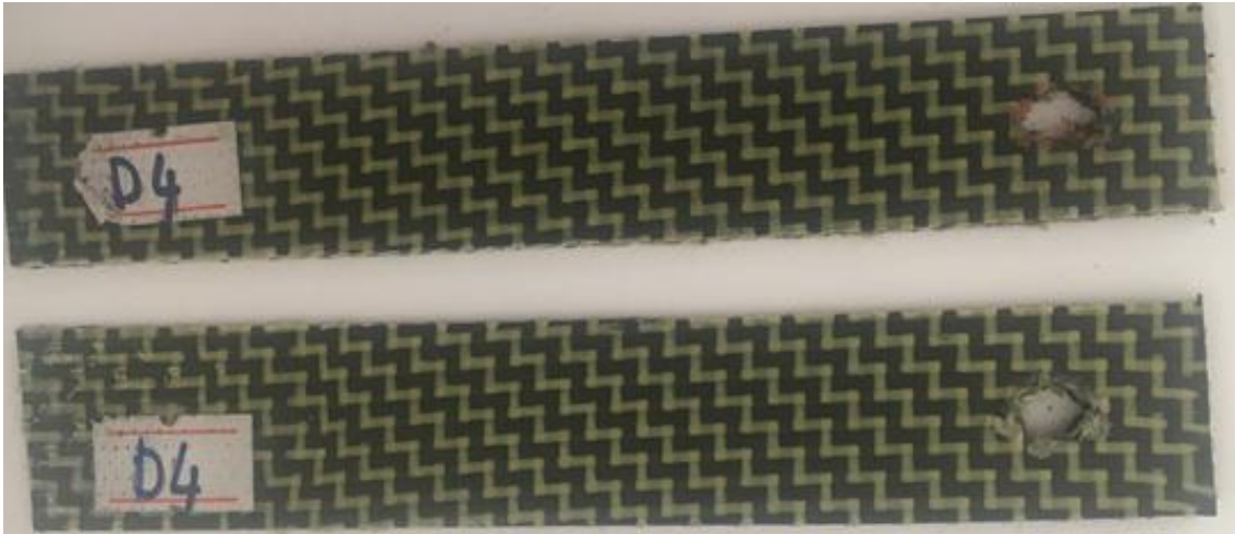
Şekil 3.106. C/H/C/H tek pim bağlantılı numunenin hasar görüntüsü.
