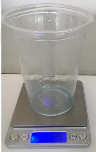
Şekil 2.6. Reçine ve sertleştirici tartılması işlemi.
