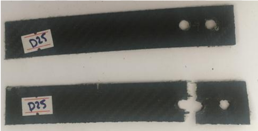
Şekil 3.93. G/G/C/C çift pim bağlantılı numunenin hasar görüntüsü.
