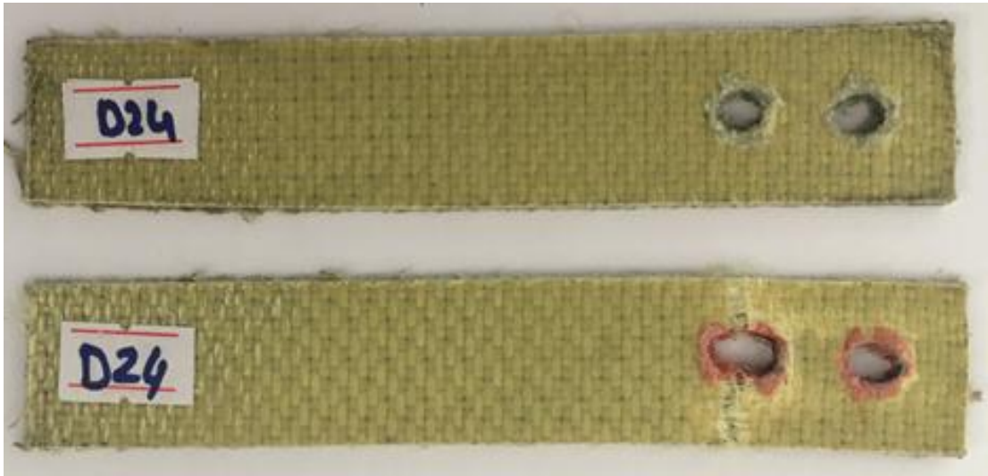
Şekil 3.78. A/C/C/A çift pim bağlantılı numunenin hasar görüntüsü.
