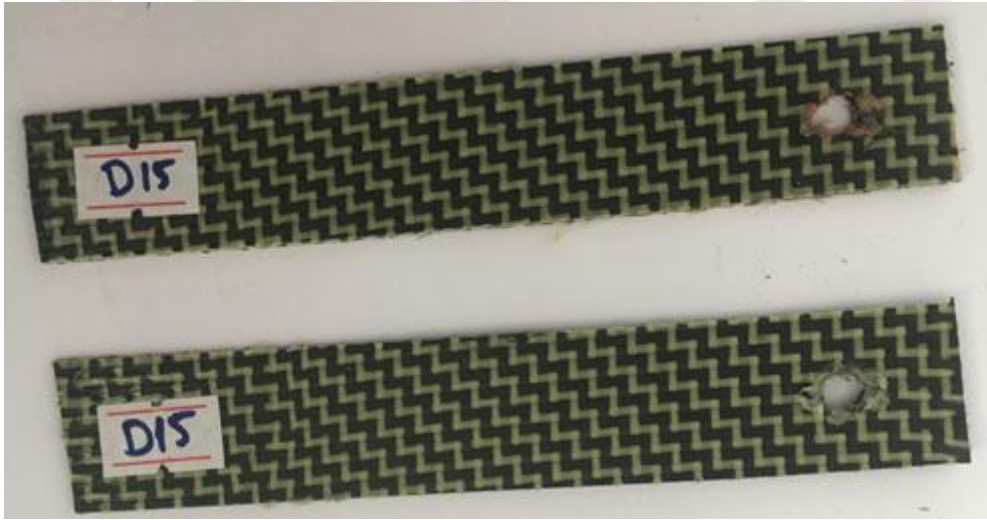
Şekil 3.126. H/G/H/G tek pim bağlantılı numunenin hasar görüntüsü.
