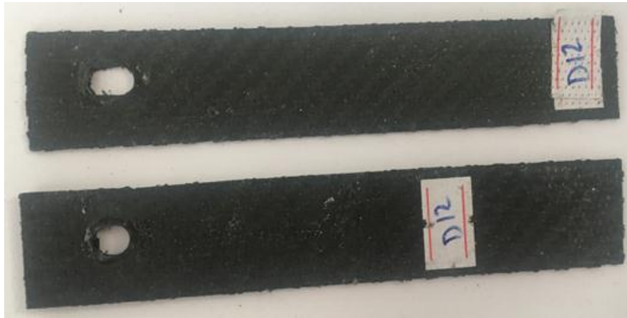
řekil 3.8. C/C/C/C tek pim baęlantılı numunenin hasar grnts.
