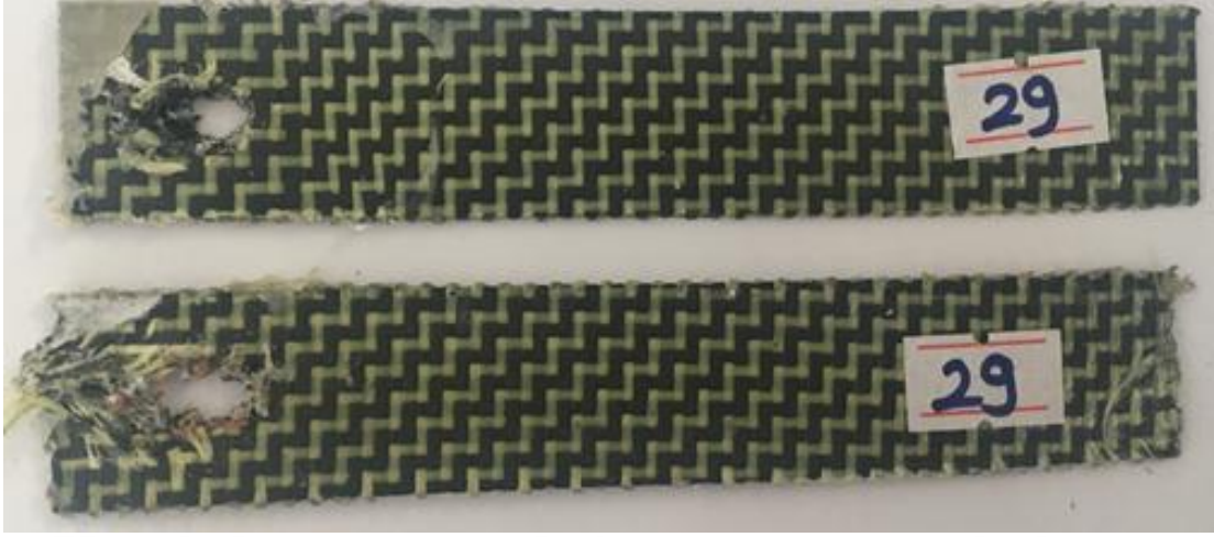
Şekil 3.157. H/H/H/H yapıştırırmalı ve tek pim bağlantılı numunenin hasar görüntüsü.
