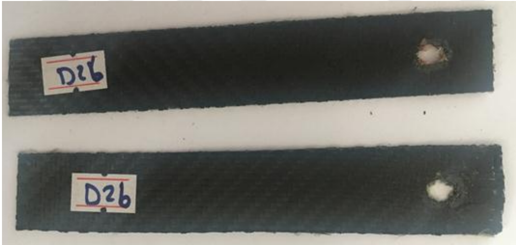
Şekil 3.86. C/G/C/G tek pim bağlantılı numunenin hasar görüntüsü.
