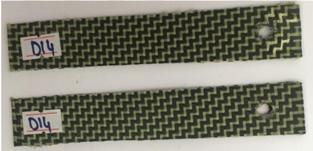
Şekil 3.136. H/G/G/H tek pim bağlantılı numunenin hasar görüntüsü.
