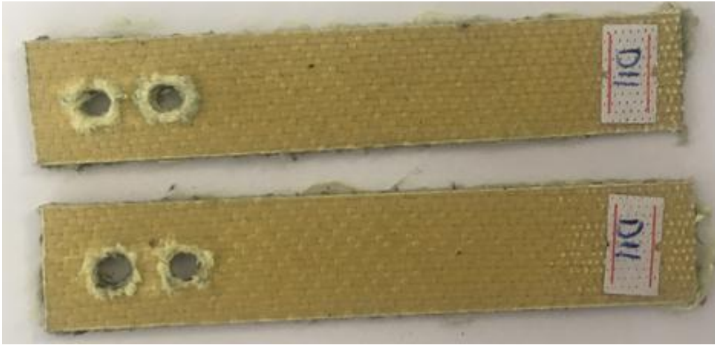
Şekil 3.15. A/A/A/A çift pim bağlantılı numunenin hasar görüntüsü.
