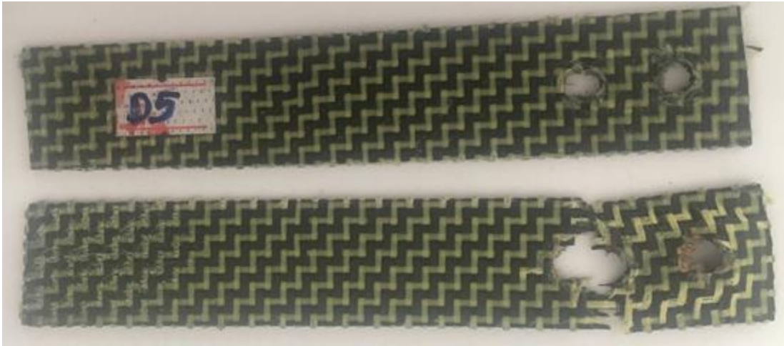
Şekil 3.123. H/C/C/H çift pim bağlantılı numunenin hasar görüntüsü
