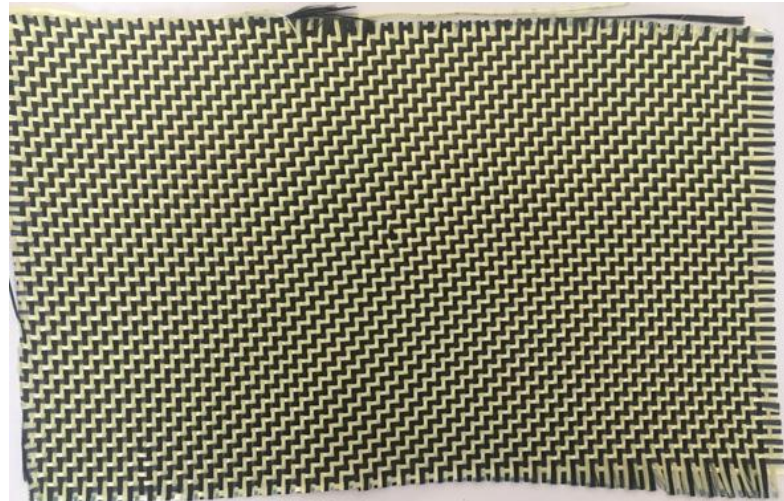
Şekil 2.2. 150-250 mm ebatlarında kesilen örgülü aramid elyaf kumaş.
