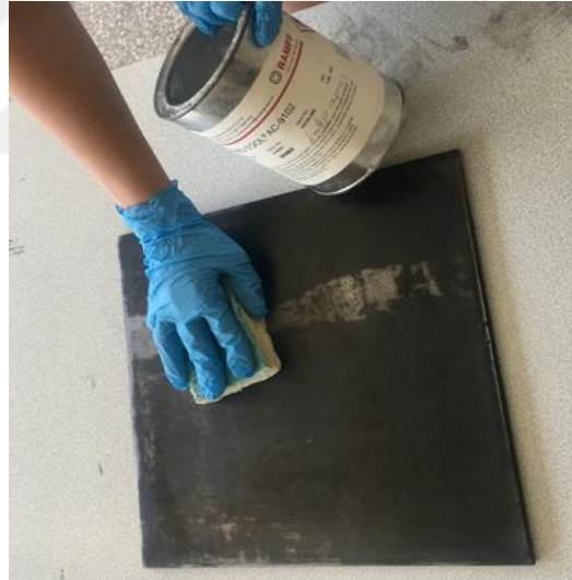
Şekil 2.4. Kalıp ayırıcının kalıba uygulama işlemi.
