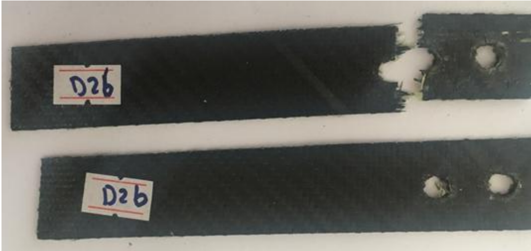
Şekil 3.88. C/G/C/G çift pim bağlantılı numunenin hasar görüntüsü.
