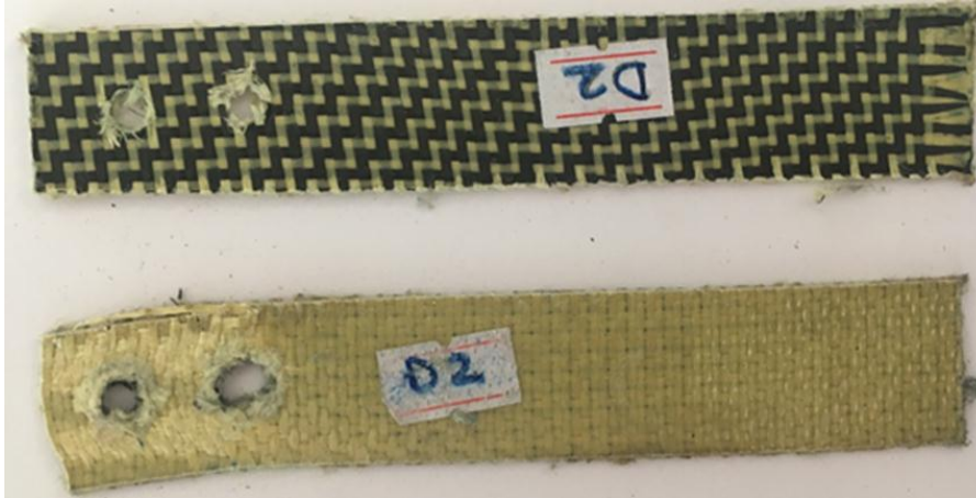
Şekil 3.45. A/H/A/H çift pim bağlantılı numunenin hasar görüntüsü.
