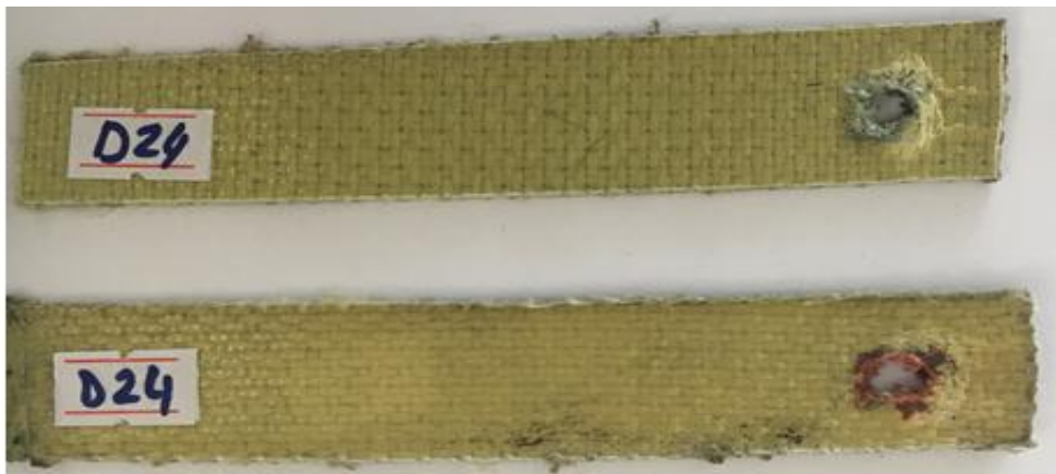
Şekil 3.76. A/C/C/A tek pim bağlantılı numunenin hasar görüntüsü.
