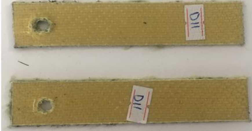
Şekil 3.13. A/A/A/A tek pim bağlantılı numunenin hasar görüntüsü.
