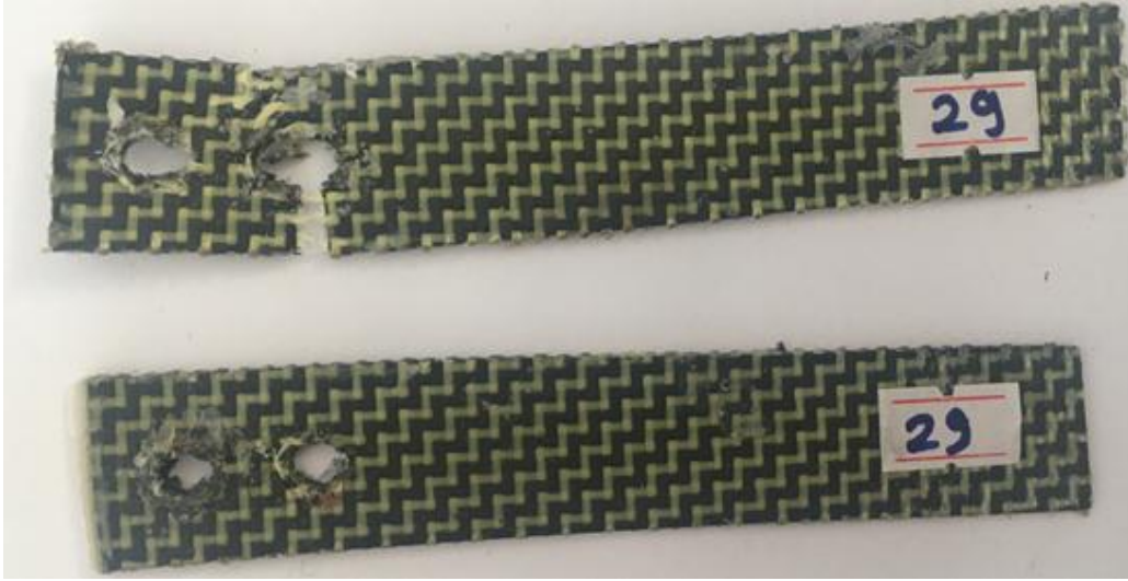
Şekil 3.159. H/H/H/H yapıştırırmalı ve çift pim bağlantılı numunenin hasar görüntüsü.
