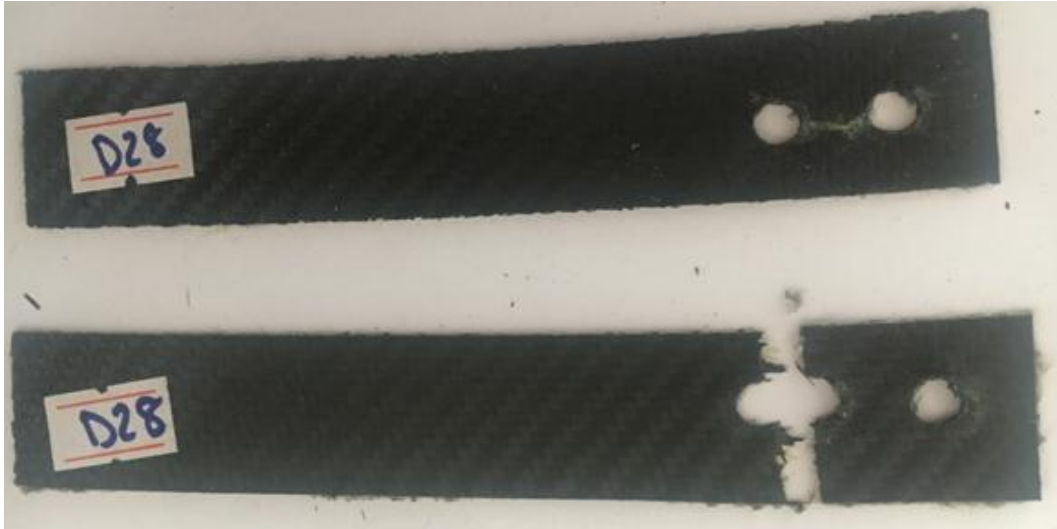
Şekil 3.103. G/C/C/G çift pim bağlantılı numunenin hasar görüntüsü.
