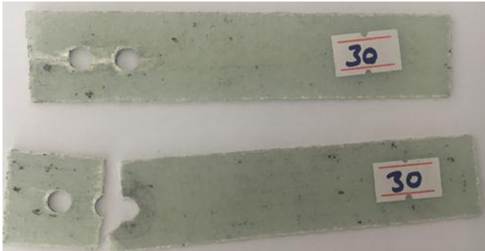
Şekil 3.147. G/G/G/G yapıştırırmalı ve çift pim bağlantılı numunenin hasar görüntüsü.
