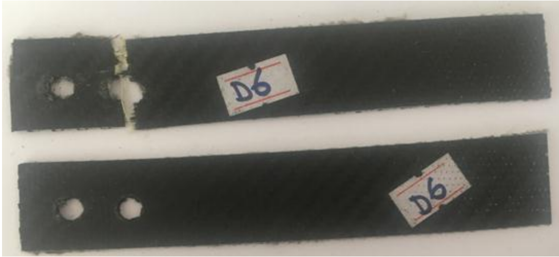
Şekil 3.118. C/H/H/C çift pim bağlantılı numunenin hasar görüntüsü
