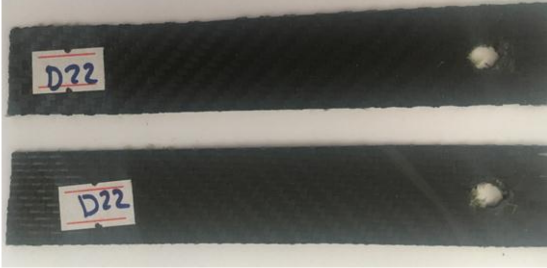
Şekil 3.81. C/A/A/C tek pim bağlantılı numunenin hasar görüntüsü.
