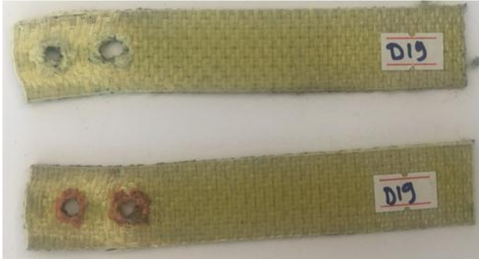
Şekil 3.25. A/G/A/G çift pim bağlantılı numunenin hasar görüntüsü.
