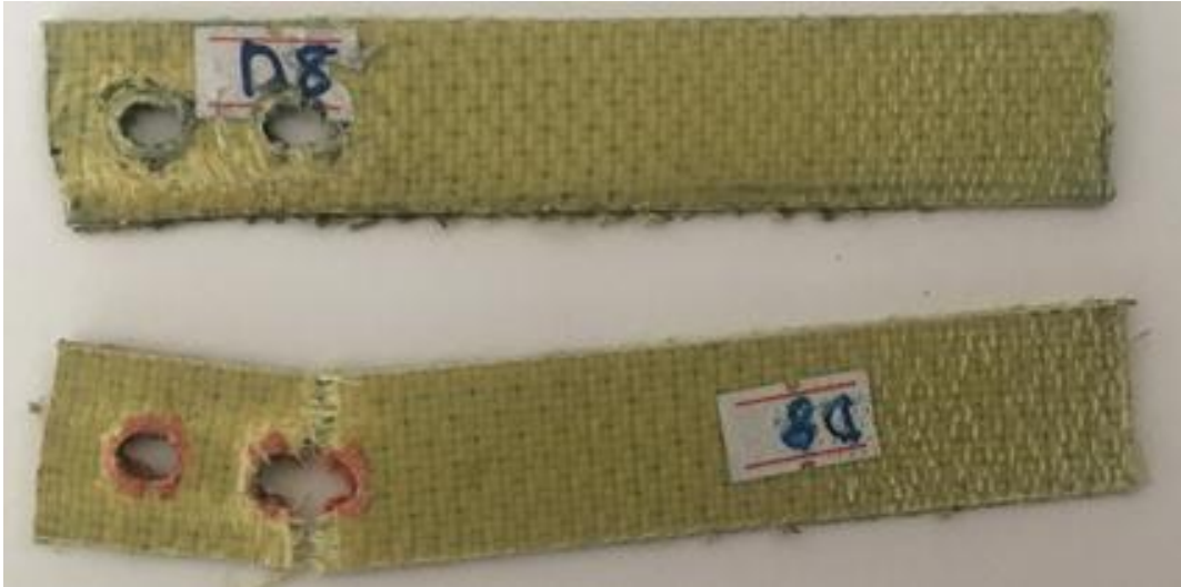
Şekil 3.55. A/H/H/A çift pim bağlantılı numunenin hasar görüntüsü
