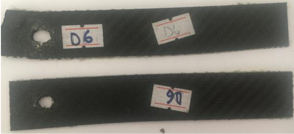
Şekil 3.116. C/H/H/C tek pim bağlantılı numunenin hasar görüntüsü.
