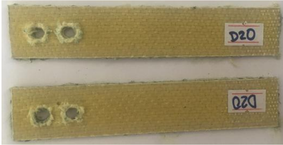
Şekil 3.40. G/A/A/G çift pim bağlantılı numunenin hasar görüntüsü.
