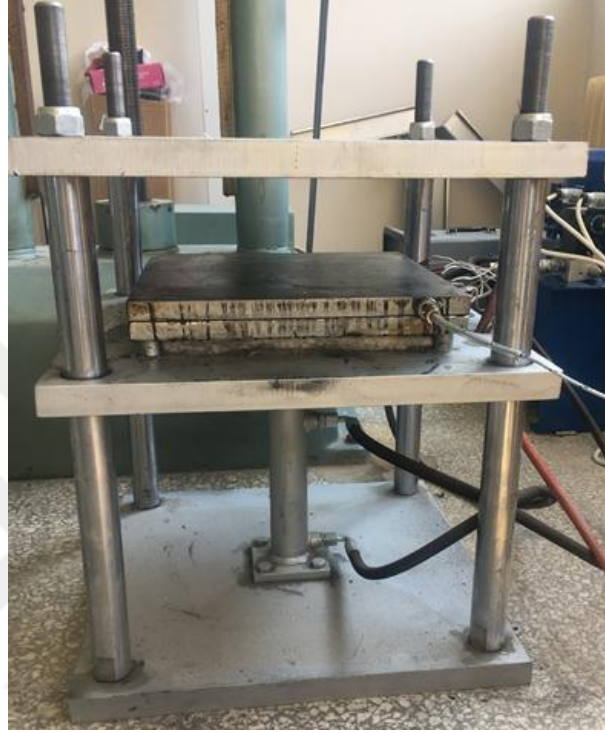
Şekil 2.1. Basınç ve sıcaklığı ayarlanabilir rezistanslı pres ünitesi.
