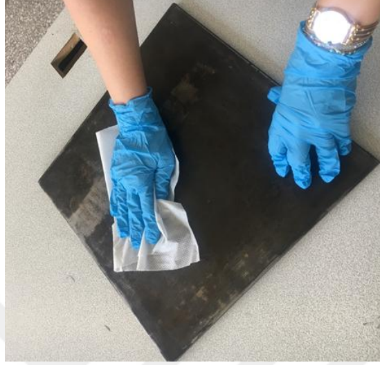
Şekil 2.3. Kalıp temizleme mendili ile metal kalıbın temizleme işlemi.
