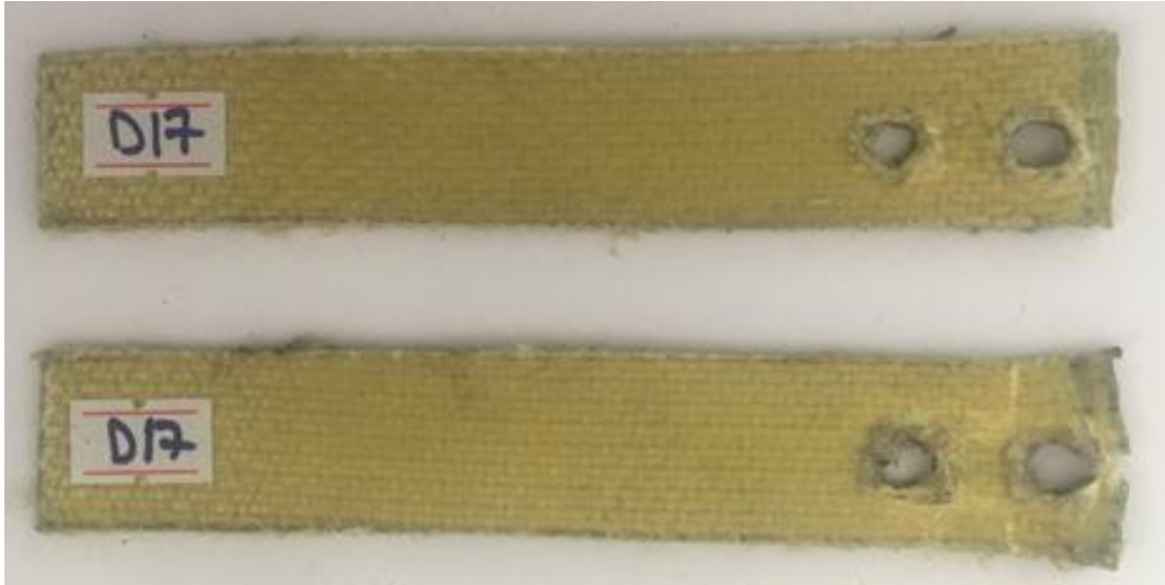
Şekil 3.30. A/A/G/G çift pim bağlantılı numunenin hasar görüntüsü.
