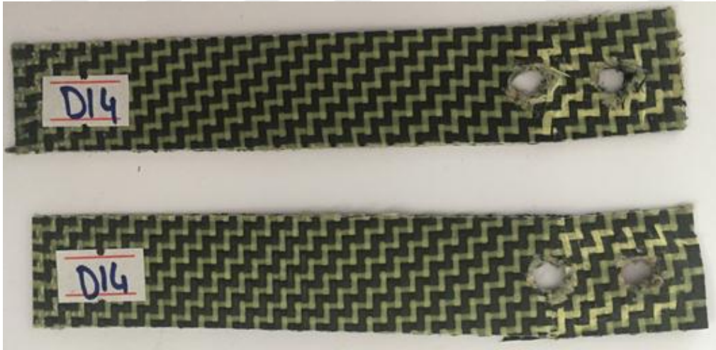
Şekil 3.138. H/G/G/H çift pim bağlantılı numunenin hasar görüntüsü
