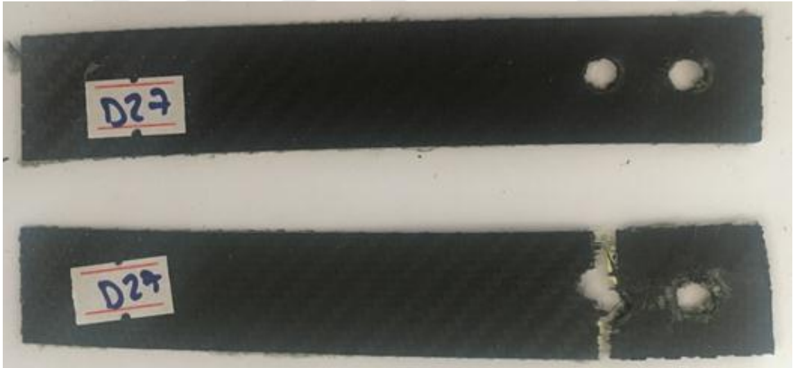
Şekil 3.98. C/G/G/C çift pim bağlantılı numunenin hasar görüntüsü
