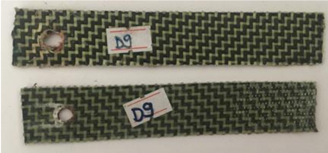
Şekil 3.18. H/H/H/H tek pim bağlantılı numunenin hasar görüntüsü.
