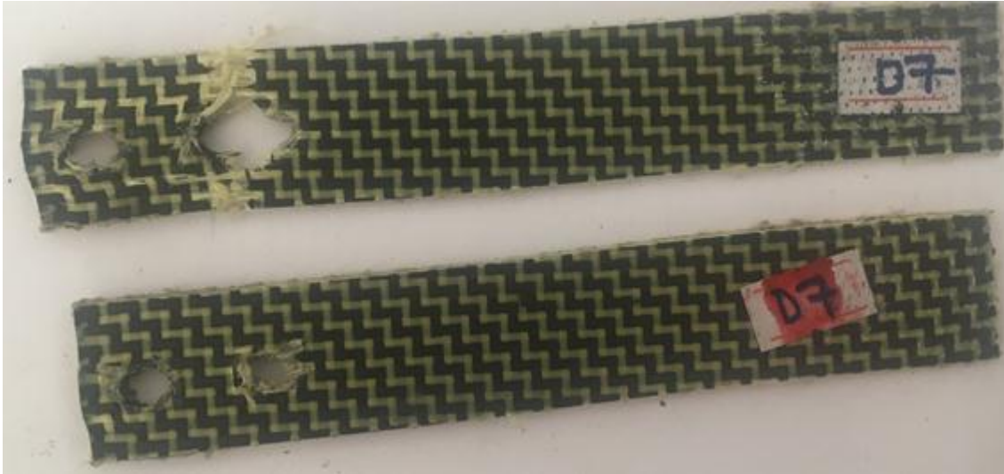
Şekil 3.50. H/H/A/A çift pim bağlantılı numunenin hasar görüntüsü.
