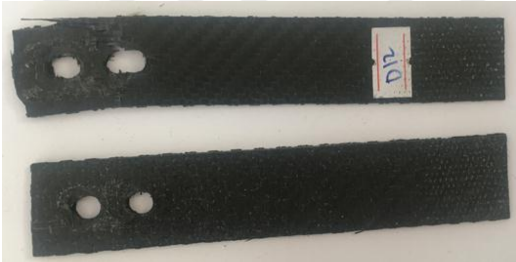
Şekil 3.10. C/C/C/C çift pim bağlantılı numunenin hasar görüntüsü.
