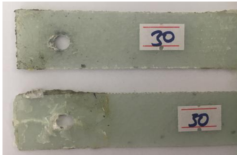
Şekil 3.145. G/G/G/G yapıştırırmalı ve tek pim bağlantılı numunenin hasar görüntüsü.
