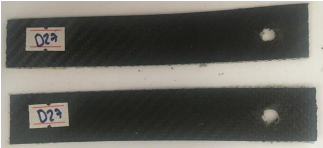
Şekil 3.96. C/G/G/C tek pim bağlantılı numunenin hasar görüntüsü.
