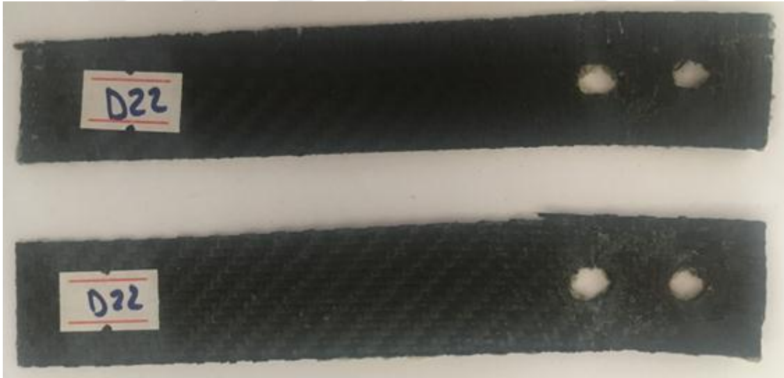
Şekil 3.83. C/A/A/C çift pim bağlantılı numunenin hasar görüntüsü.
