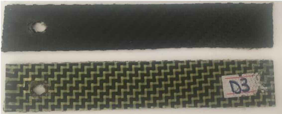
Şekil 3.111. C/C/H/H tek delikli numunenin hasar görüntüsü.
