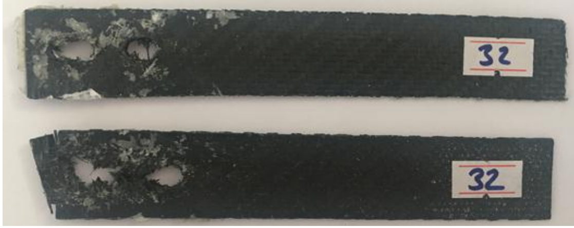
Şekil 3.151. C/C/C/C yapıştırırmalı ve çift pim bağlantılı numunenin hasar görüntüsü.
