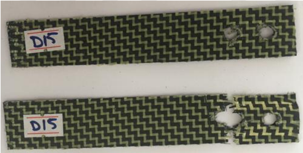
Şekil 3.128. H/G/H/G çift pim bağlantılı numunenin hasar görüntüsü.
