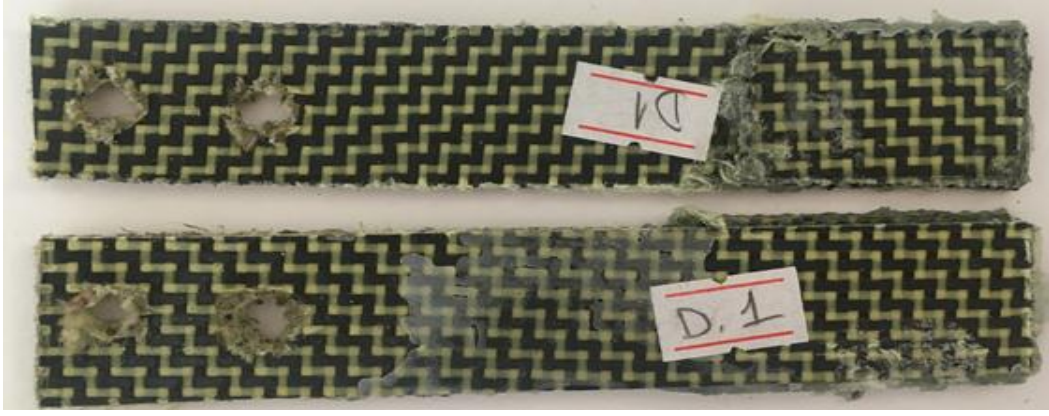
Şekil 3.63. H/A/A/H çift pim bağlantılı numunenin hasar görüntüsü.
