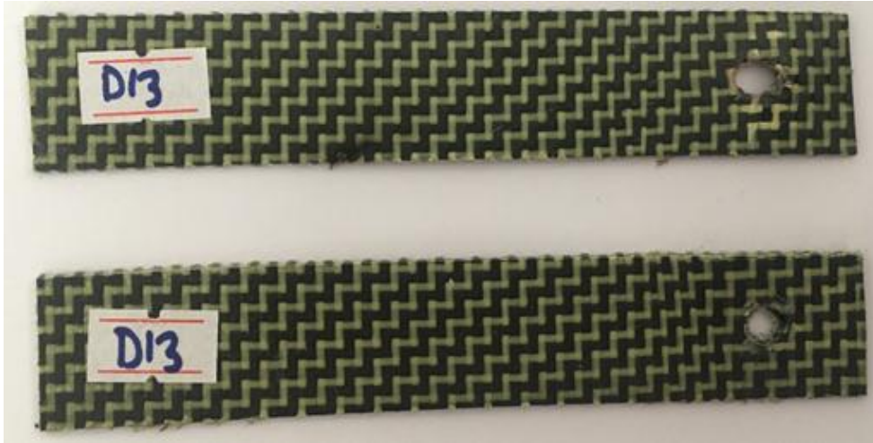
Şekil 3.131. H/H/G/G tek pim bağlantılı numunenin hasar görüntüsü.
