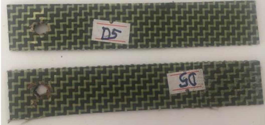
Şekil 3.121. H/C/C/H tek pim bağlantılı numunenin hasar görüntüsü.
