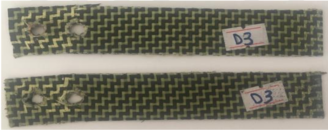
Şekil 3.113. C/C/H/H çift pim bağlantılı numunenin hasar görüntüsü
