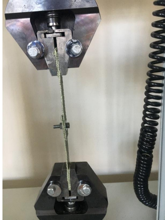
Şekil 3.58. H/A/A/H tek pim bağlantılı numunenin çekme deneyi.
