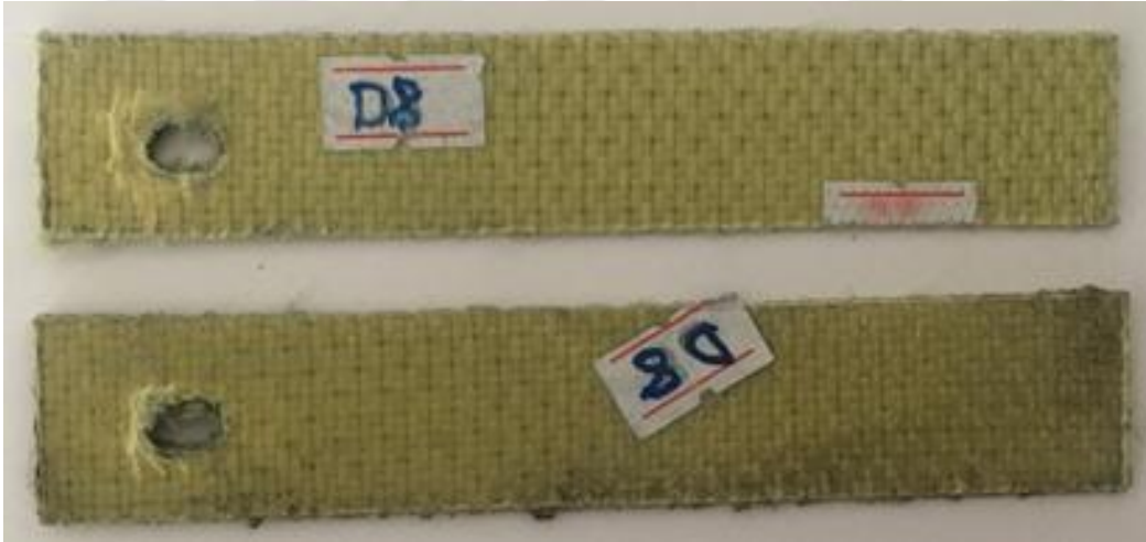
Şekil 3.53. A/H/H/A tek pim bağlantılı numunenin hasar görüntüsü.
