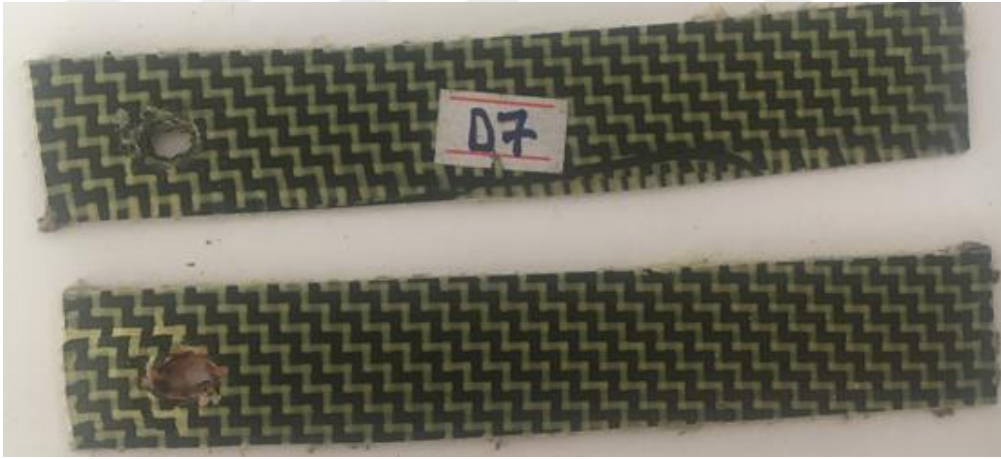
Şekil 3.48. H/H/A/A tek pim bağlantılı numunenin hasar görüntüsü.
