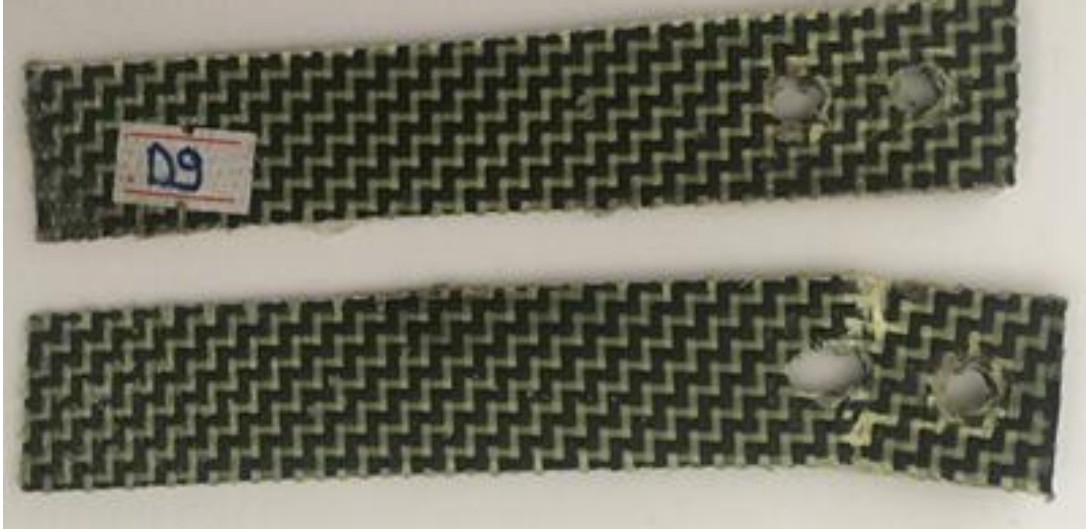
Şekil 3.20. H/H/H/H çift pim bağlantılı numunenin hasar görüntüsü.
