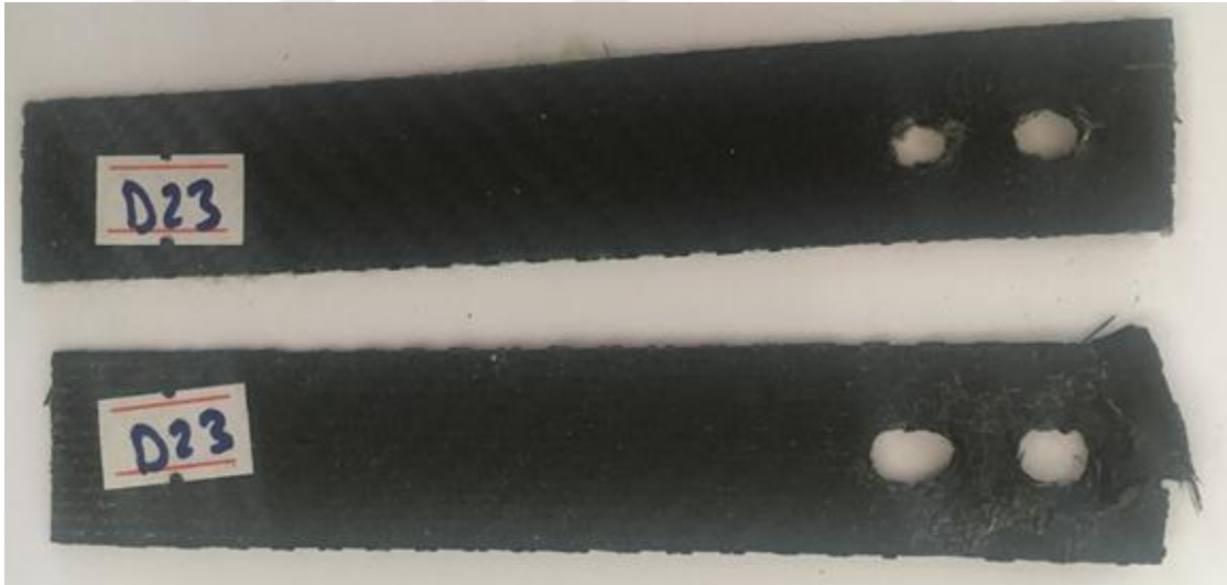
Şekil 3.68. A/C/A/C çift pim bağlantılı numunenin hasar görüntüsü.
