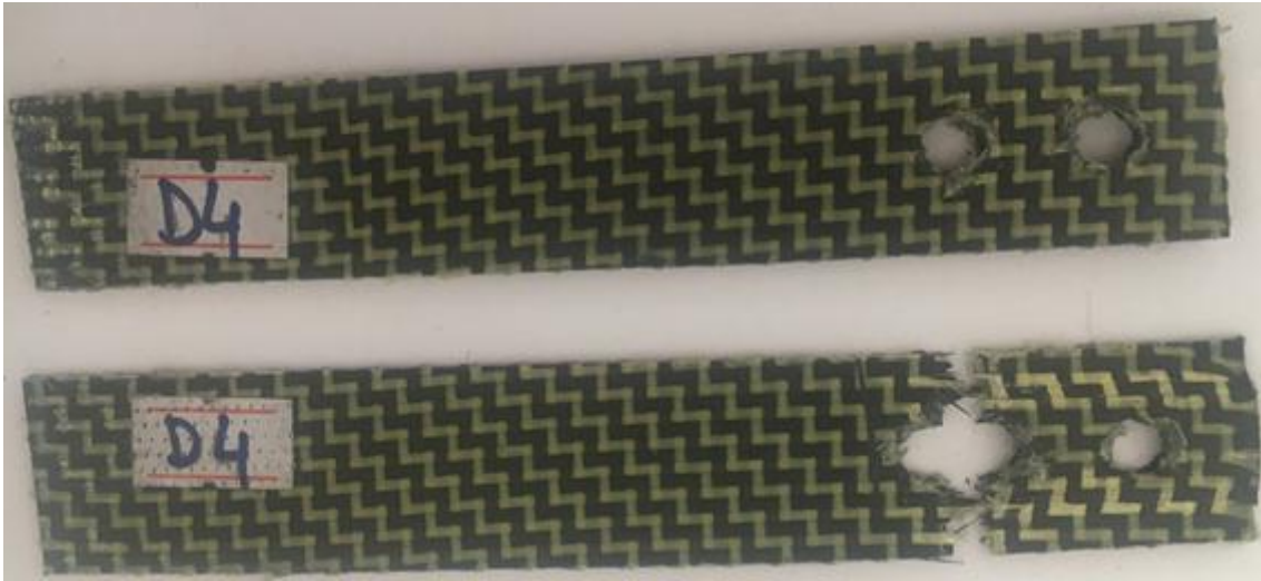
Şekil 3.108. C/H/C/H çift delik numunenin hasar görüntüsü.
