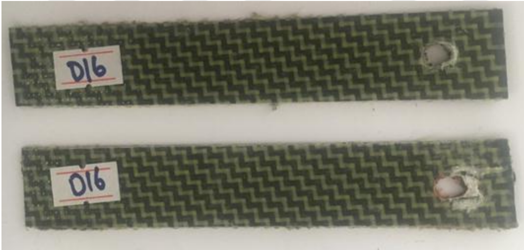
Şekil 3.141. G/H/H/G tek pim bağlantılı numunenin hasar görüntüsü
