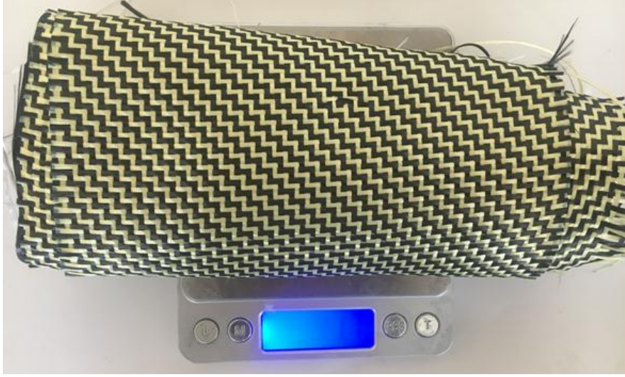
Şekil 2.5. Kullanılacak kumaş ağırlığının hassas tartı ile ölçümü.
