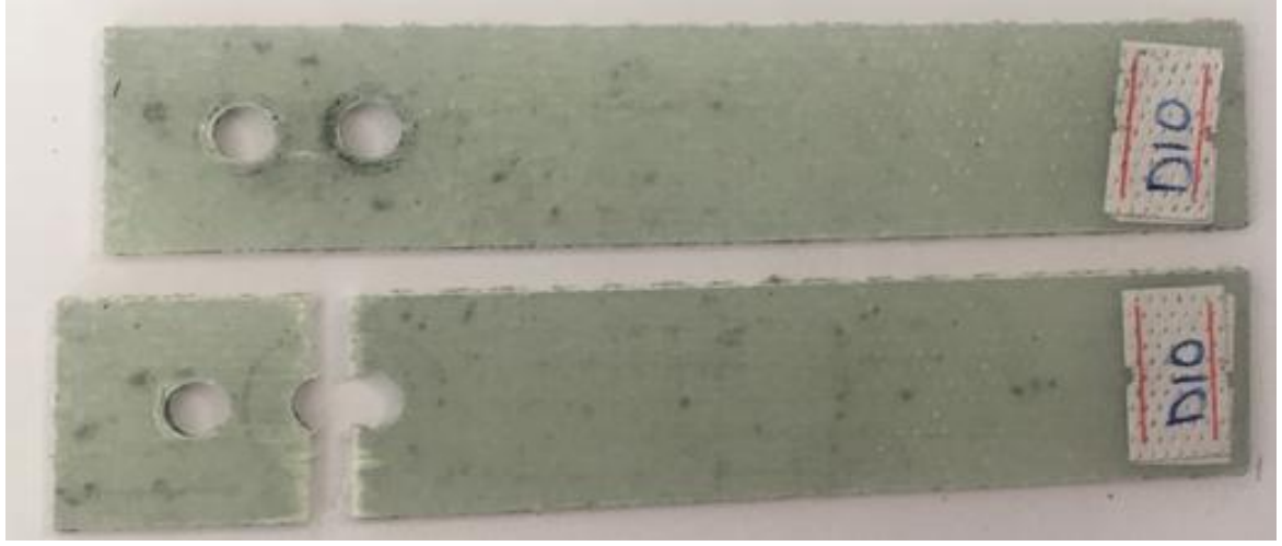
Şekil 3.5. G/G/G/G çift pim bağlantılı numunenin hasar görüntüsü.
