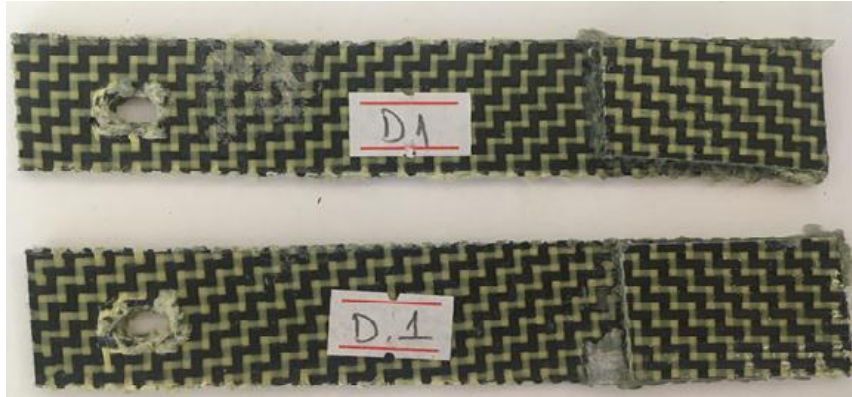
Şekil 3.60. H/A/A/H tek pim bağlantılı numunenin hasar görüntüsü.
