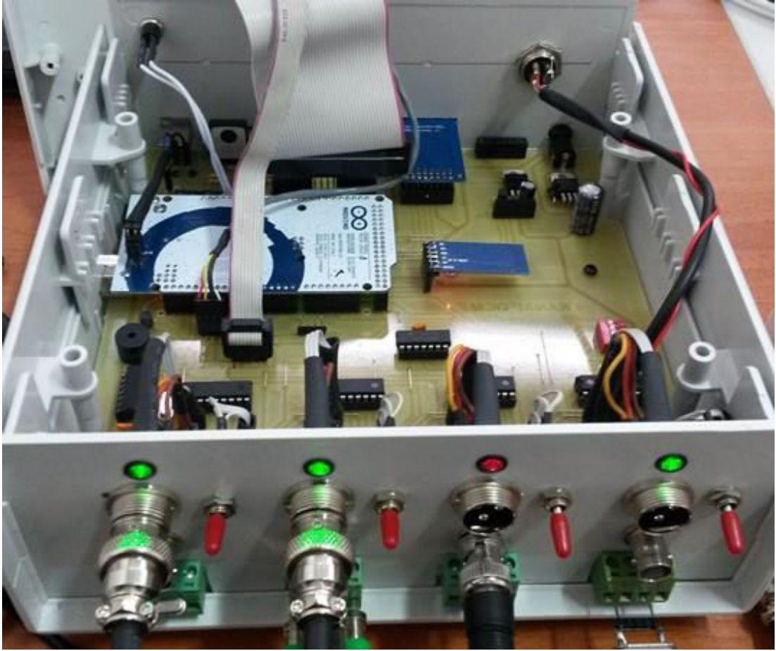
Şekil 3.32: KKM ölçüm cihazının içyapısı.
