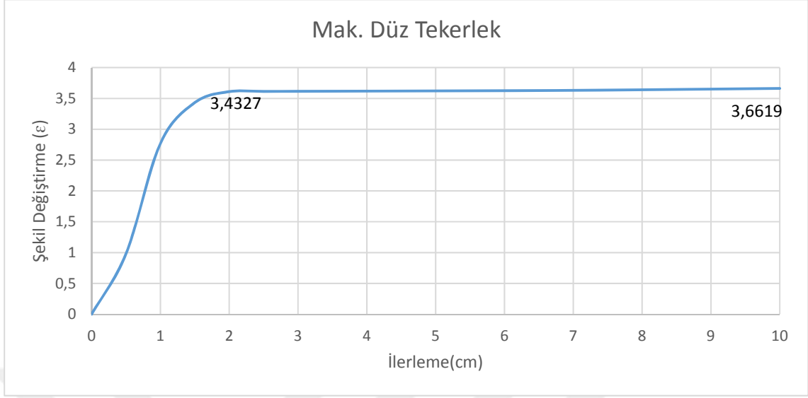
Şekil 4.16. Düz tekerlek modelinin karda maksimum şekil değişirgesi değerleri
