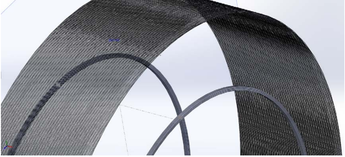
Şekil 3 .11. Tekerlekte gövde ve topukta kullanılan teller
