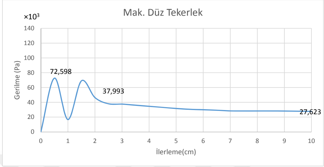
Şekil 4.18. Düz tekerlek modelinin kardaki maksimum gerilme değerleri
