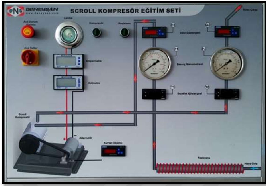
Şekil 3.2. Scroll tip genişletici kullanan güç üretim sisteminin görünümü
