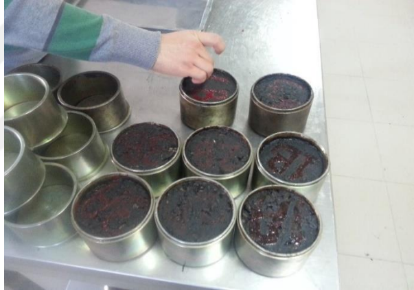
Resim 3.4 Marshall briketlerin kalıplar içindeki durumu.
