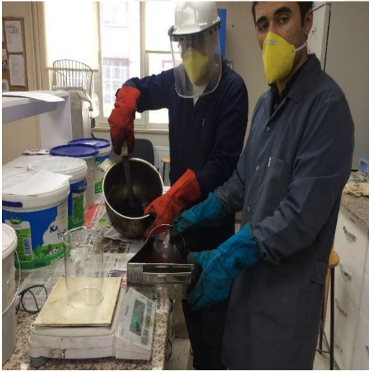
Resim 3.10 Hazırlanan TMA karışımın boş behere boşaltılması ve deney sonu boş beher.
