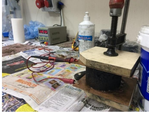
Resim 3.8 İki elektrotlu yöntemi ile özdirenç ölçümü.
