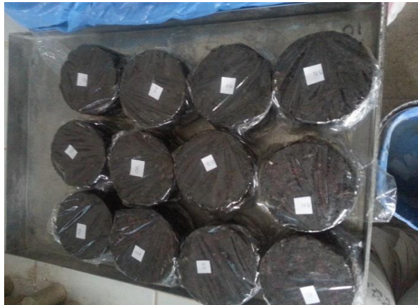
Resim 3.5 Marshall briketlerinin kalıplardan çıkartılmış durumu.
