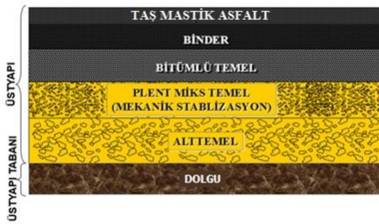
Resim 2.2 Asfalt kaplamanın uygulama katmanları (Int. Kyn.3).
