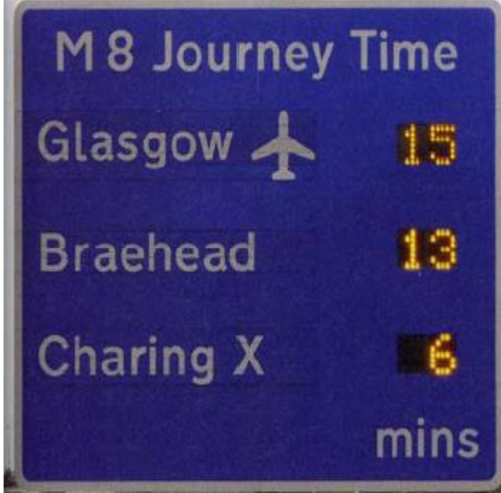
Resim 2.2. Avrupa ve İskoçya'da kullanılan yarı dinamik DMİ [16]
