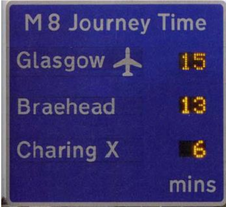
Resim 4.8. Avrupa ve İskoçya’da kullanılan yarı dinamik DMİ [16]
