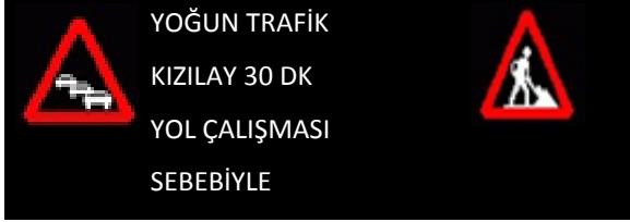
Şekil 5.9. Yoğun trafik için iki piktogramlı uygulama
