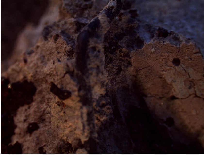
Şekil 04.31. 600 °C sıcaklığa maruz kalan beton numunesi
