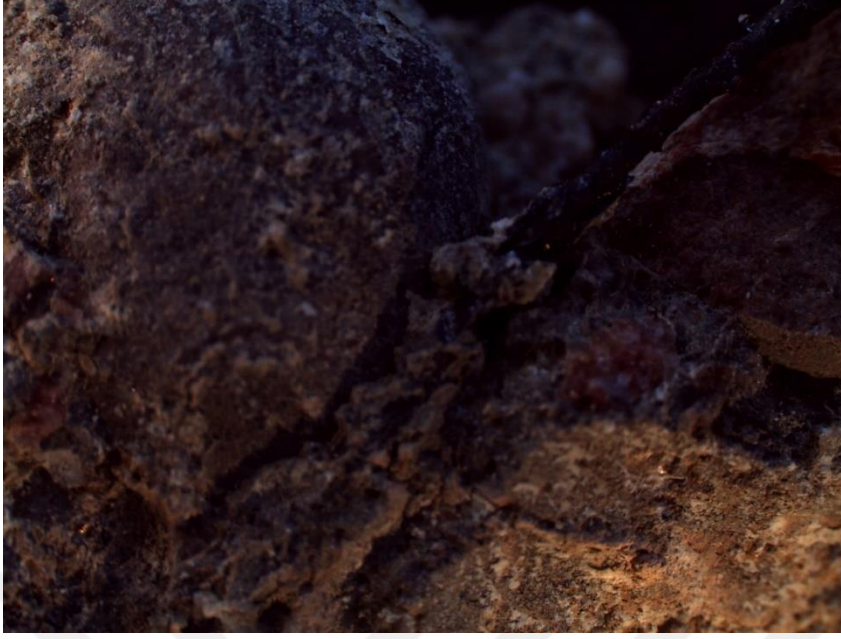
Şekil 04.33. 800 °C sıcaklığa maruz kalan beton numunesi
