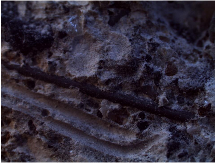
Şekil 4.27. 200 °C sıcaklığa maruz kalan beton numunesi
