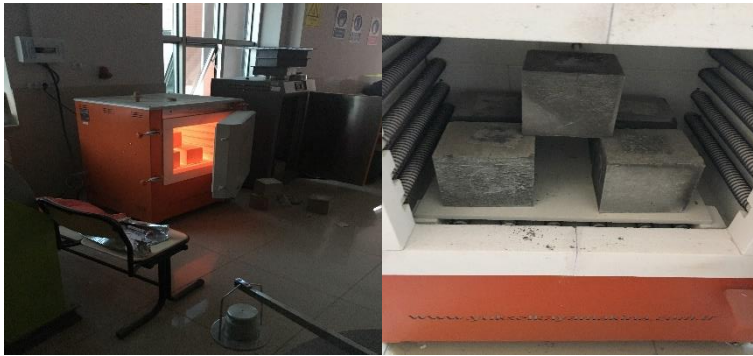
Şekil 03.12. Yüksek sıcaklık fırınındaki numuneler
