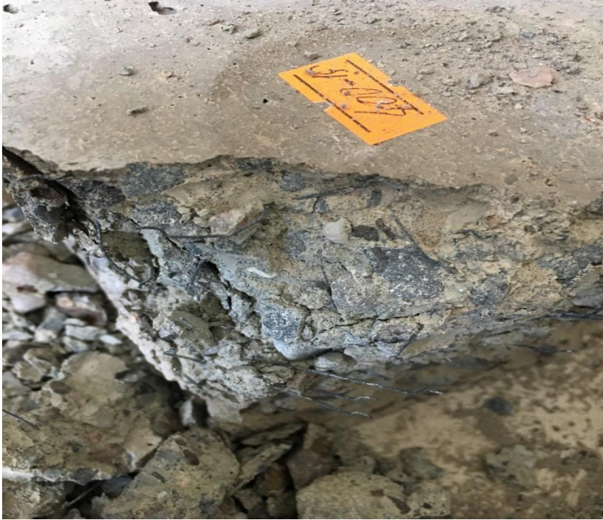
Şekil 4.23. 400 °C’de beton içerisindeki çelik liflerin görüntüsü
