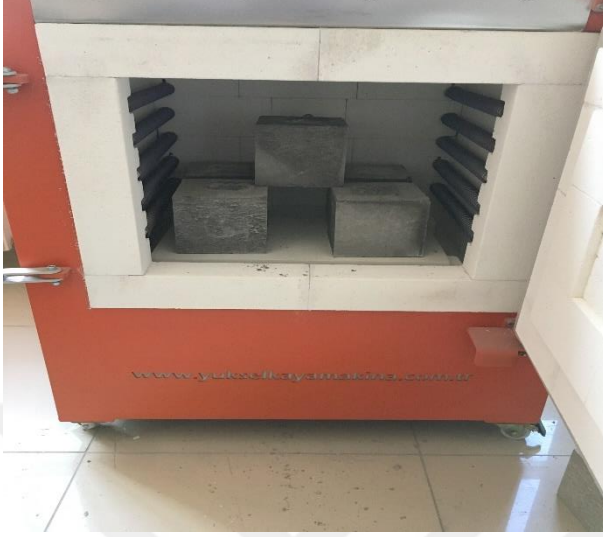
Şekil 4.19. 600 °C sıcaklıktan sonra beton numunesi
