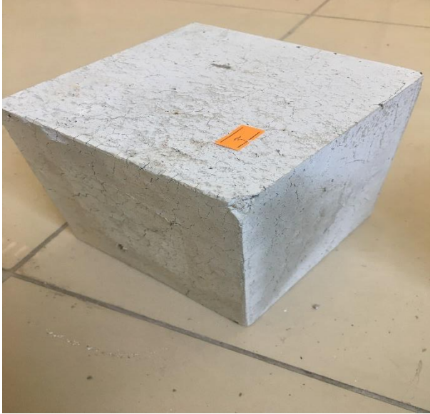
Şekil 04.20. 800 °C sıcaklıktan sonra beton numunesi
