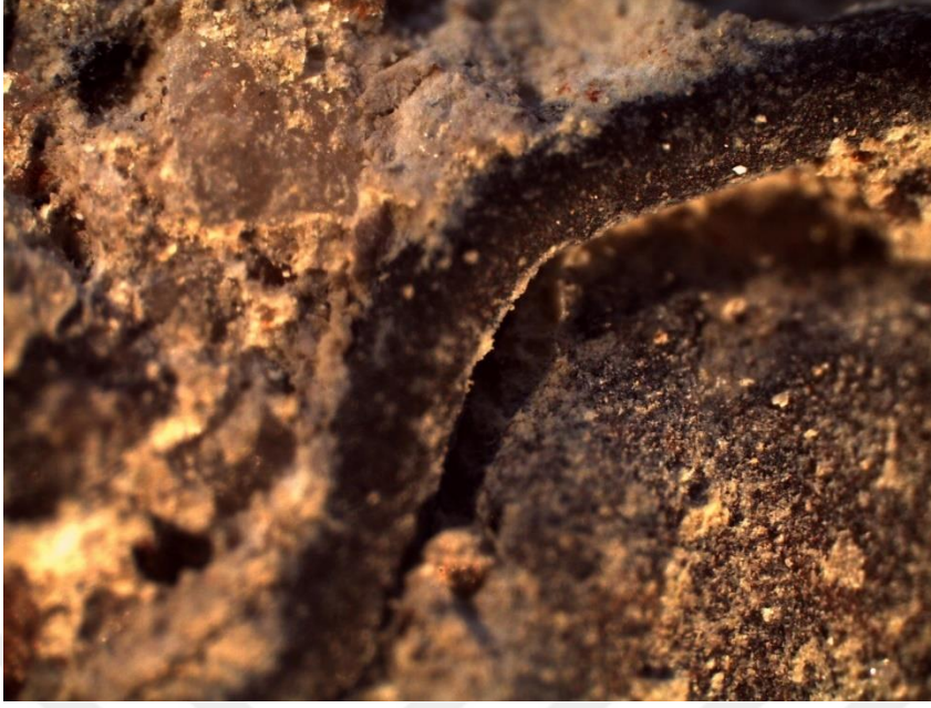
Şekil 4.28. 400 °C sıcaklığa maruz kalan beton numunesi
