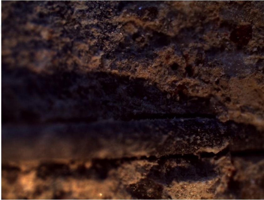
Şekil 04.30. 600 °C sıcaklığa maruz kalan beton numunesi
