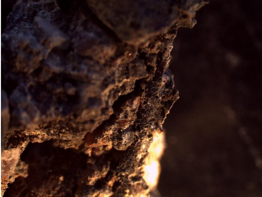
Şekil 04.32. 800 °C sıcaklığa maruz kalan beton numunesi
