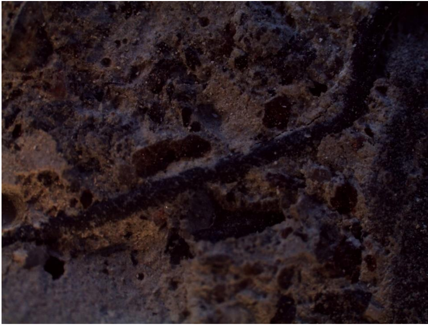
Şekil 04.29. 400 °C sıcaklığa maruz kalan beton numunesi
