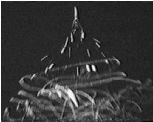
Resim 2.2. Jetin toplayıcı kısma ilerlerken davranışı (Reneker ve Yarin, 2008)
