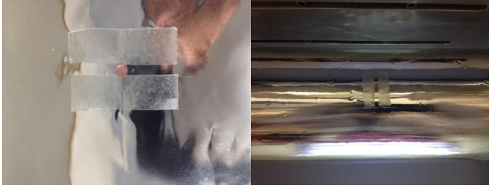
Resim 3.3. TEM görüntüleri alınması amacıyla alüminyum folyoya grid uygulanması
