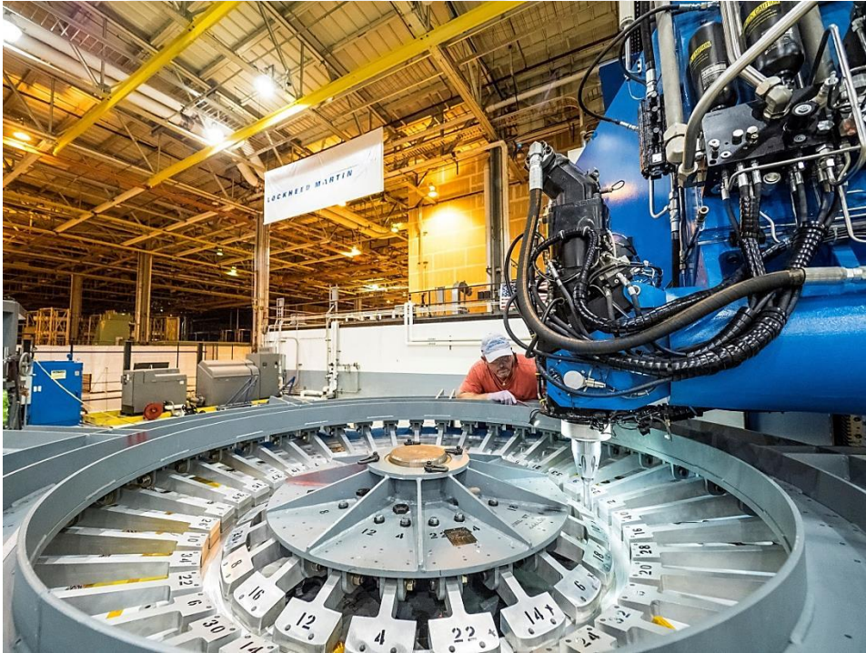
Şekil 1.24. Uzay aracının tünel ve ön bölümünün SKK ile birleştirilmesi [56].
