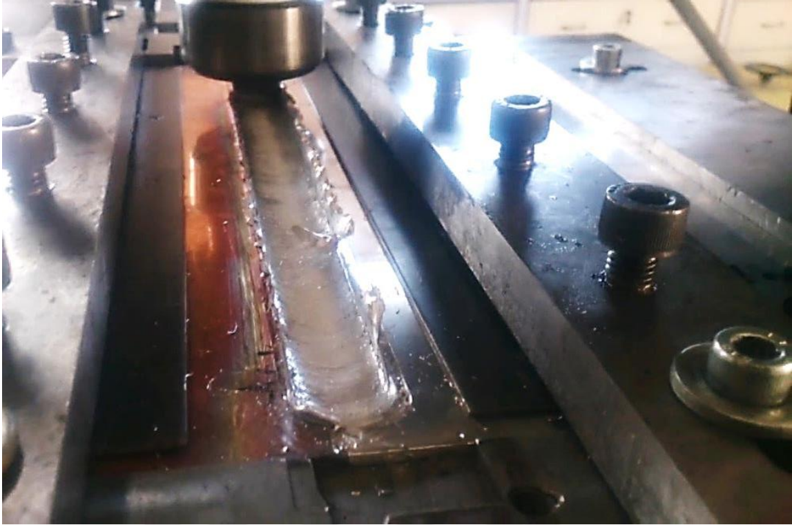
Şekil 3.9. Al-Cu levhaların SKK ile kaynaklı birleştirilmesi.
