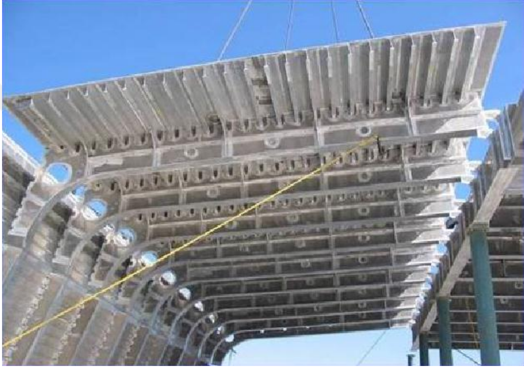
Şekil 1.27. SKK yöntemi ile üretilen gemi güvertesi [59].
