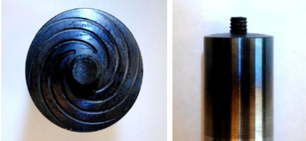
Şekil 1.22. Oyuk küresel omuzlu ve silindirik dişli pime sahip takım [36].
