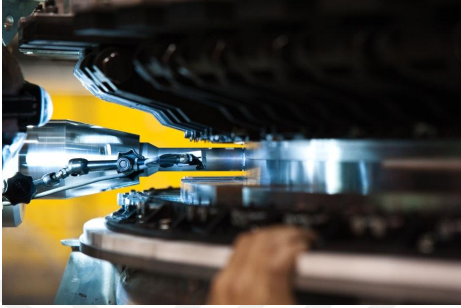
Şekil 1.23. Uzay aracının bölme ve konik burnunun SKK ile birleştirilmesi [55].
