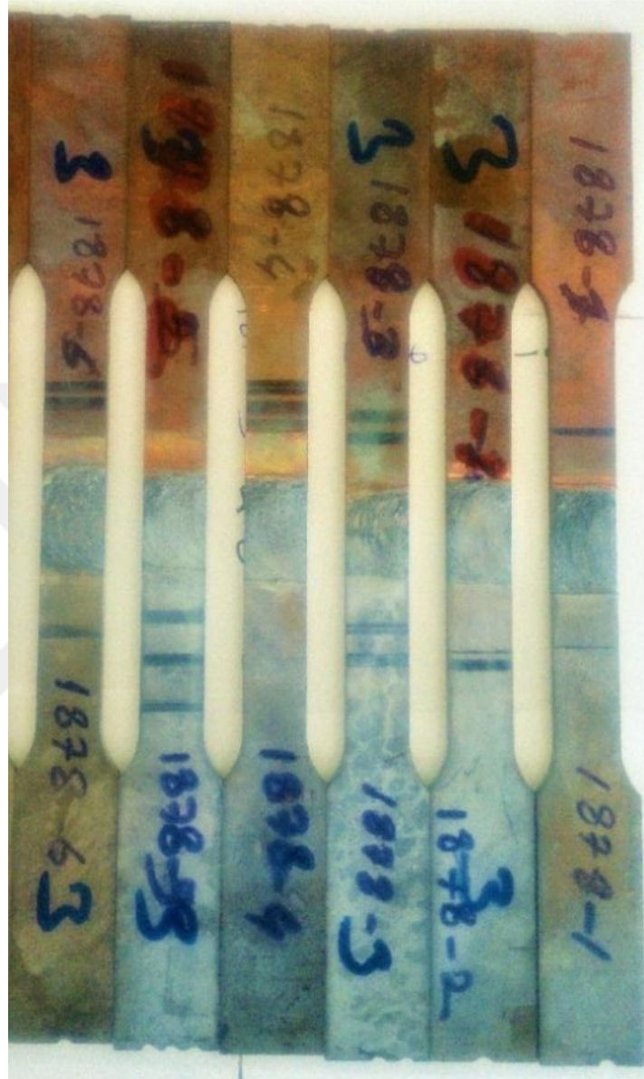
Şekil 3.2. Kaynaklı plakalardan elde edilen çekme test numuneleri.
