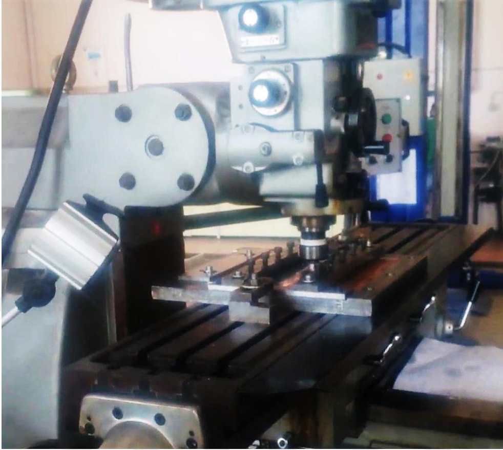
Şekil 3.5. SKK işlemi için kullanılan düşey başlıklı universal freze tezgahı.
