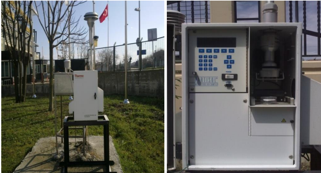
Şekil 3.2: Partisol FRM Model 2000 Air Sampler cihazı.
