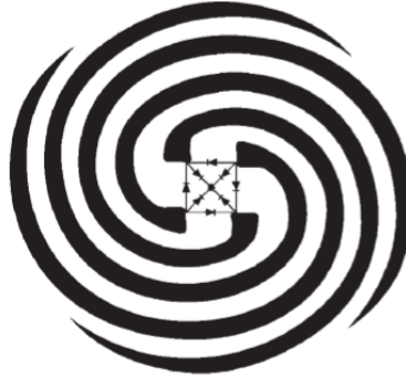
Şekil 1.2. Merkezi olarak anahtarlama diyotlu, yansıtıcı antenin dört kollu spiral modeli [1]
