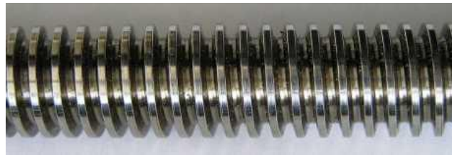
Şekil 2.11. 29° Trapez Vida: Diş açısı 29^\circ olan, çapların adımları 25,4 mm'deki vida diş sayısı olarak belirtilen vidalardır – ACME Leadscrew [9]
