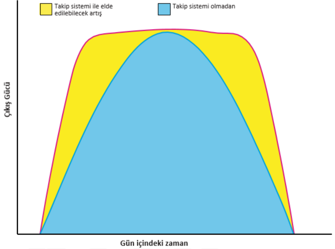
Şekil 3.5 Sabit açılı ve güneş takip sistemli tesis üretim grafiklerinin karşılaştırılması (IFC, 2015)
