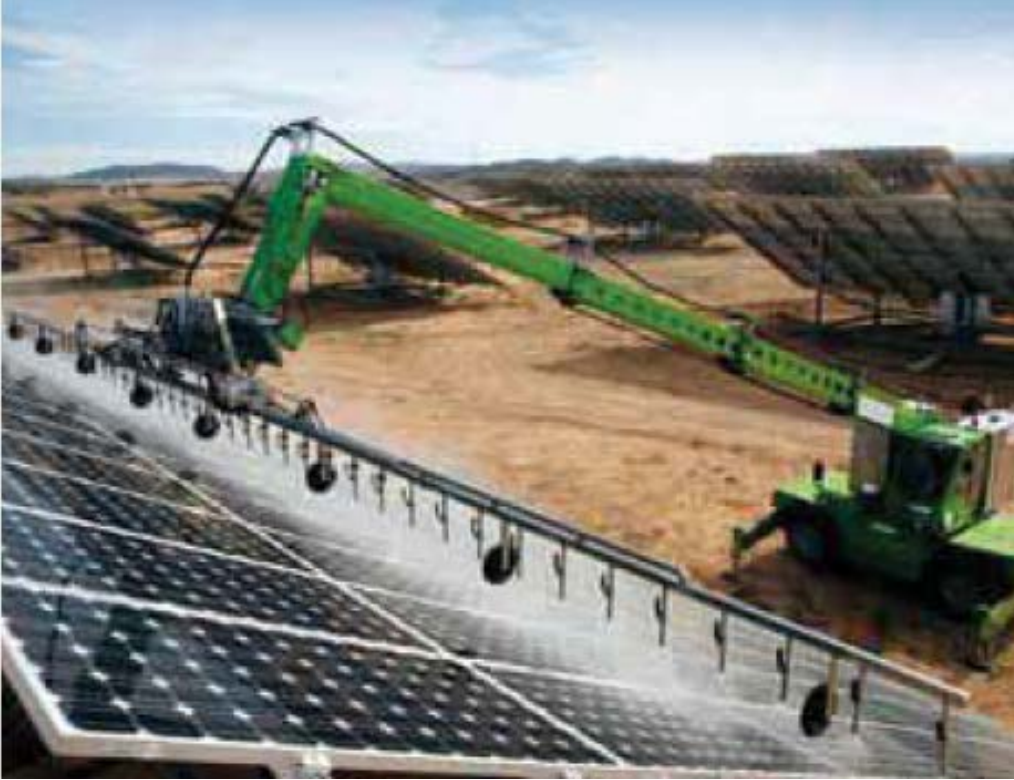
Şekil 3.7 Suyla yıkama ile modül temizliği (IFC, 2015)
