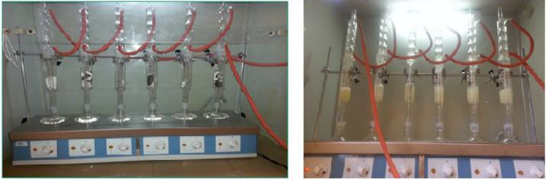
Şekil 4.6. Filtrelerin ve PUF'ların ekstraksiyonu
