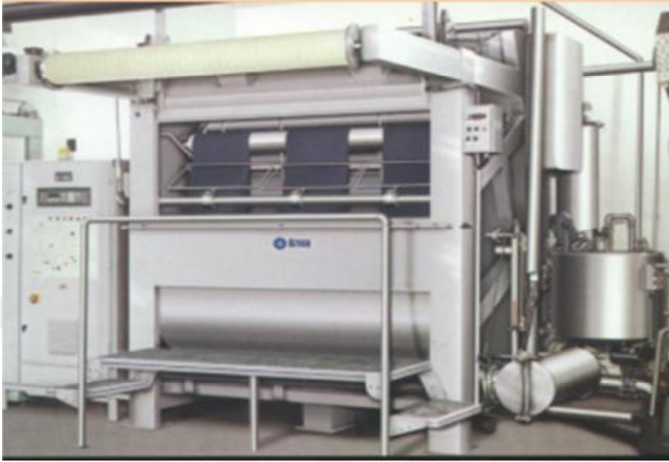
Şekil 3.17. Açık en HT haspel boyama makinesi ( https://tekstilsayfasi.blogspot.com.tr , 2016)
