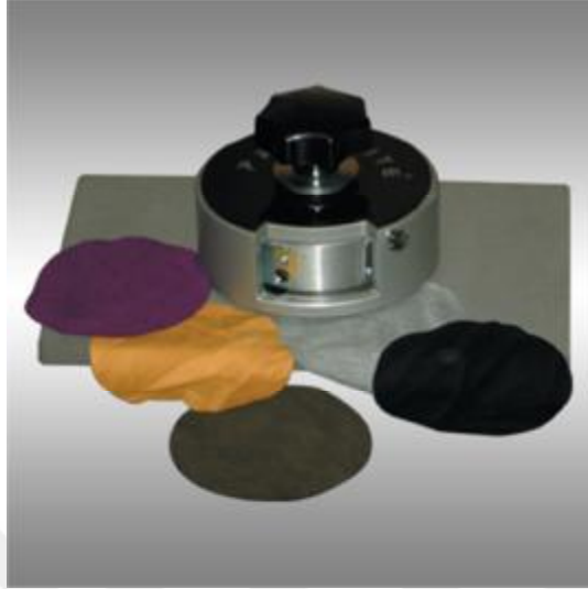
Şekil 4.1. Gramaj kesme aparatı ( http://www.pro-ser.com , 2016)
