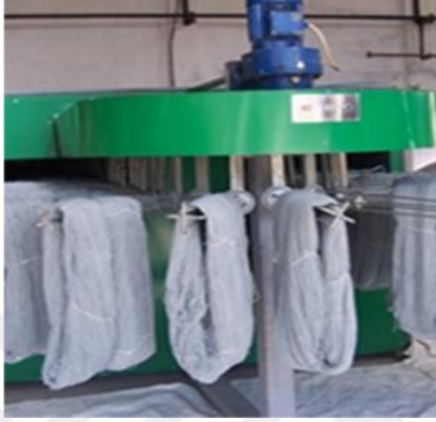
Şekil 3.1. Çile boyama yöntemi
