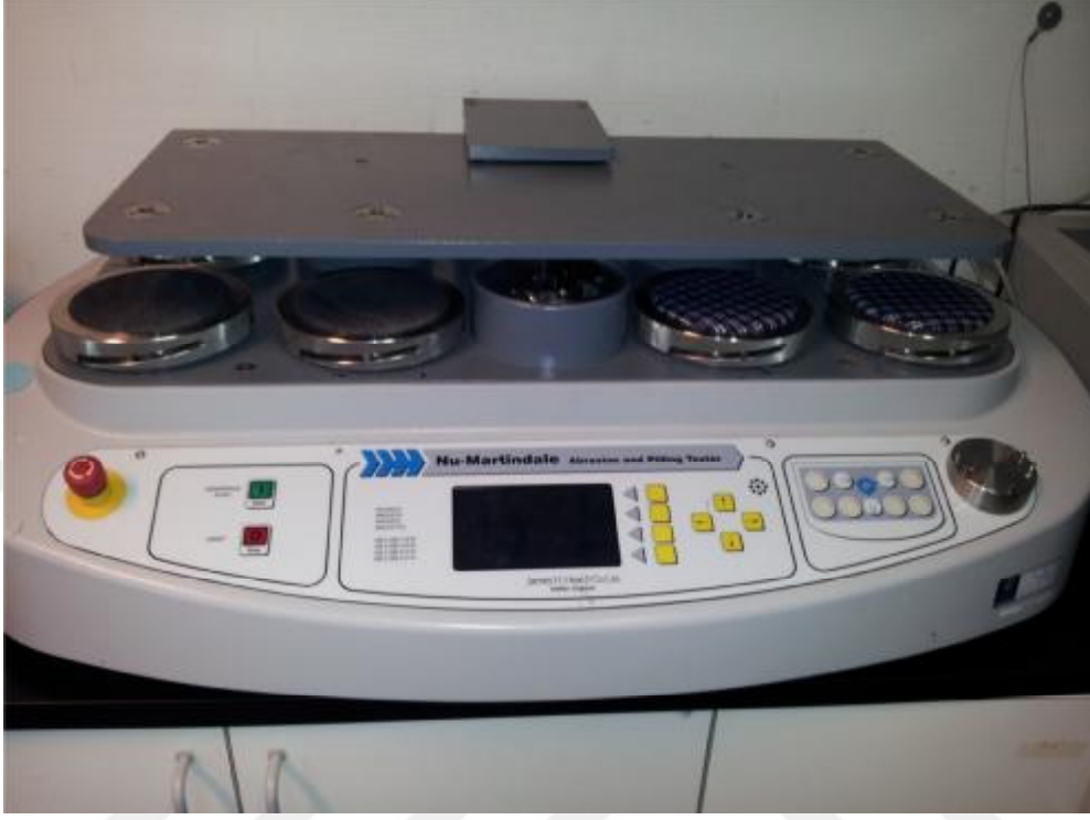
Şekil 4.4. Martindale pilling cihazı
