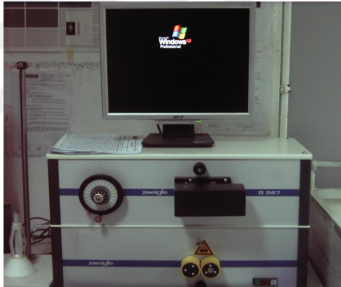
Şekil 2.7. Zweigle MT-G 567 tüylülük test cihazı.
