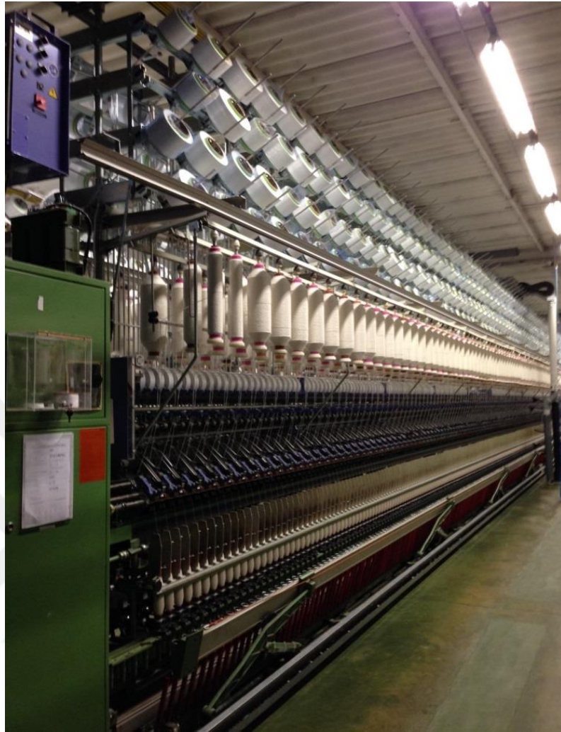
Şekil 1.7. Ring iplik makinesinde dual core-spun iplik üretimi.
