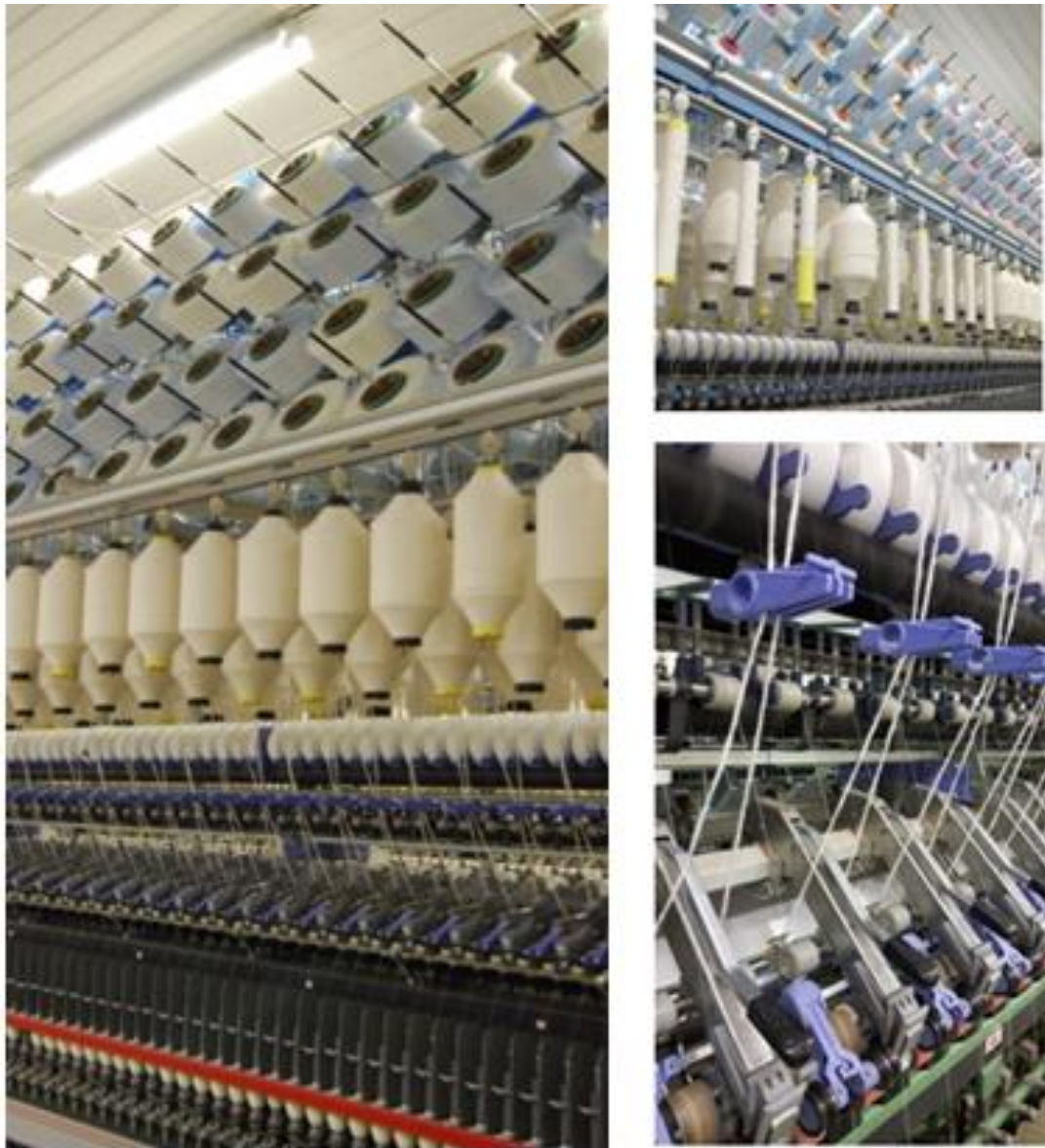
Şekil 2.3. Ring iplik makinesinde dual core-spun eğirme metodu.
