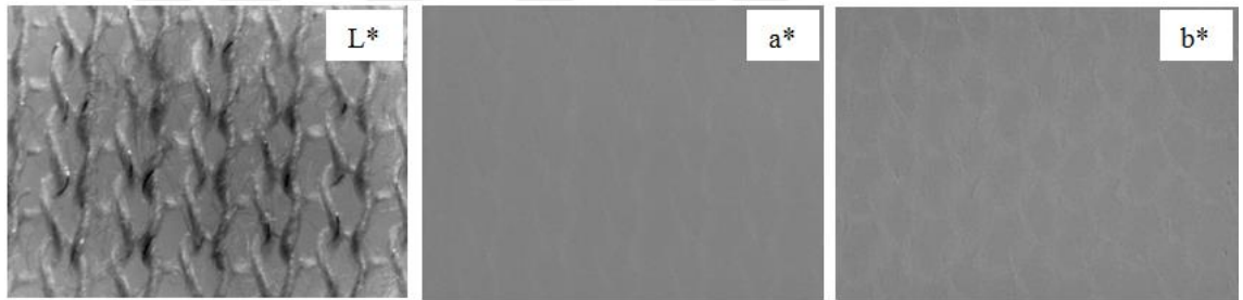
Şekil 2.16. 30RC kodlu kumaşın Lab uzayında L^*a^*b^* komponentleri.
