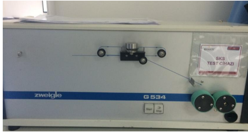
Şekil 2.8. Zweigle G 534 sürtünme test cihazı.
