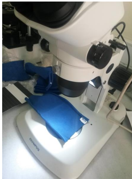
Şekil 2.28. Stereo mikroskop ile görüntünün alınması.
