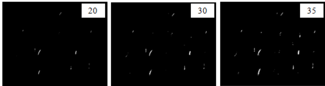
Şekil 2.21. 20, 30, 35 piksel değerlerinde eşikleme sonucu oluşan 30RC görüntüleri.
