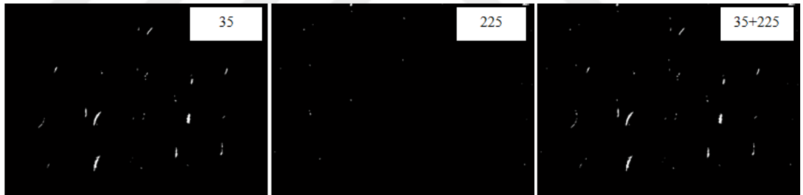
Şekil 2.25. 35, 225 ve 35+225 piksel değerlerinde eşikleme sonucu oluşan 30RC görüntüleri.
