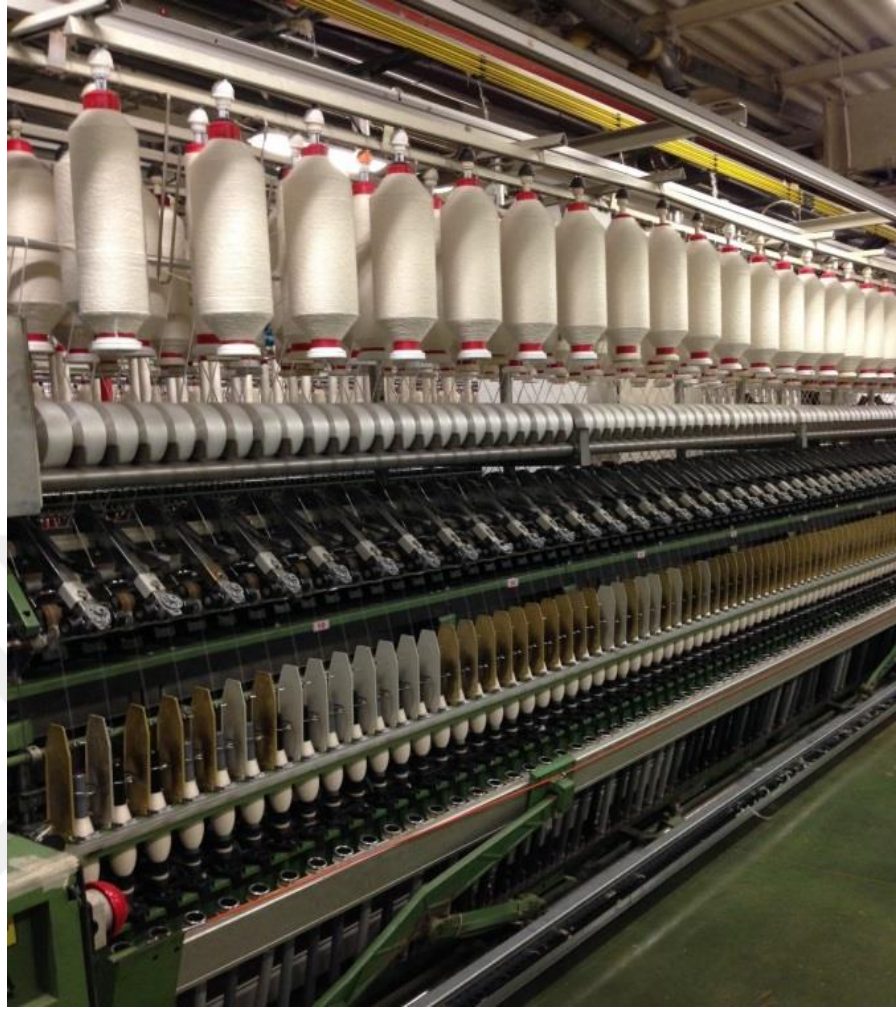
Şekil 1.6. Ring iplik makinesinde core-spun iplik üretimi.
