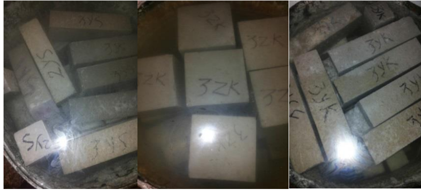
Şekil 3.16. Su küründeki numuneler
