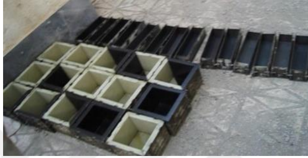
Şekil 3.5. Beton numune kalıpları
