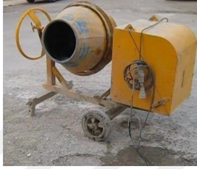
Şekil 3.3. Beton üretiminde kullanılan laboratuvar tipi betonyer
