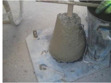
Şekil 3.10. Beton üretimi ve taze betonda çökme deneyi
