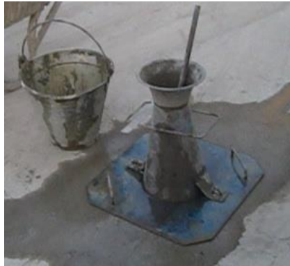
Şekil 3.4. Beton çökme konisi ve şişleme çubuğu
