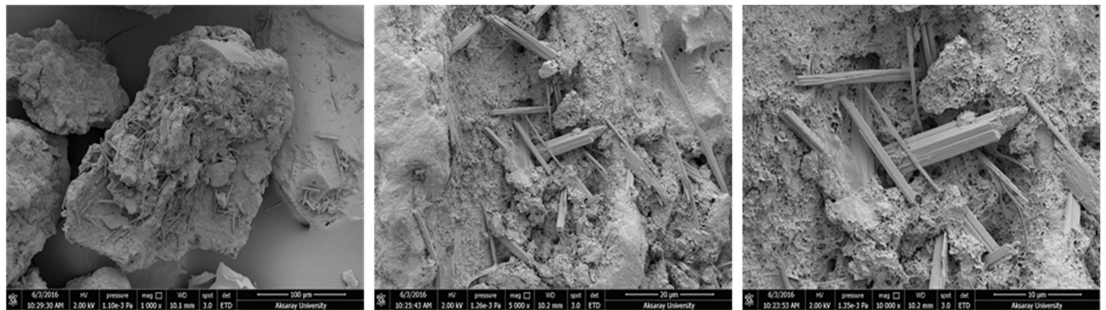
Şekil 4.26 : Ni 2+ 'nin volkanik tüt ile adsorpsiyon sonrası SEM görüntüsü.
