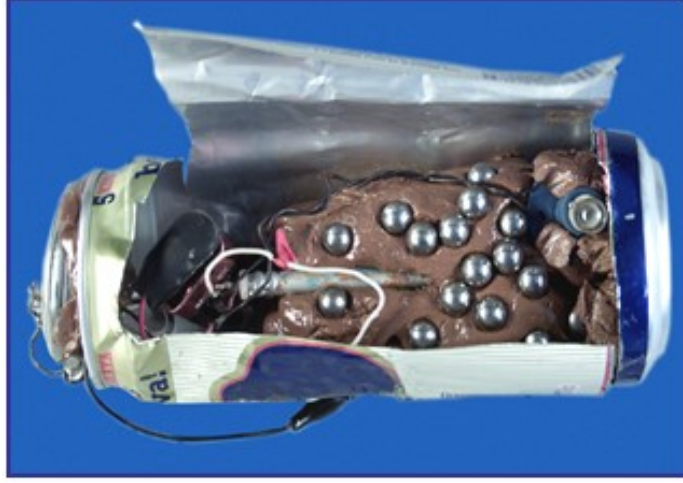
Şekil 2.4: Sarsıntı ile devreye giren EYP düzeneği.
