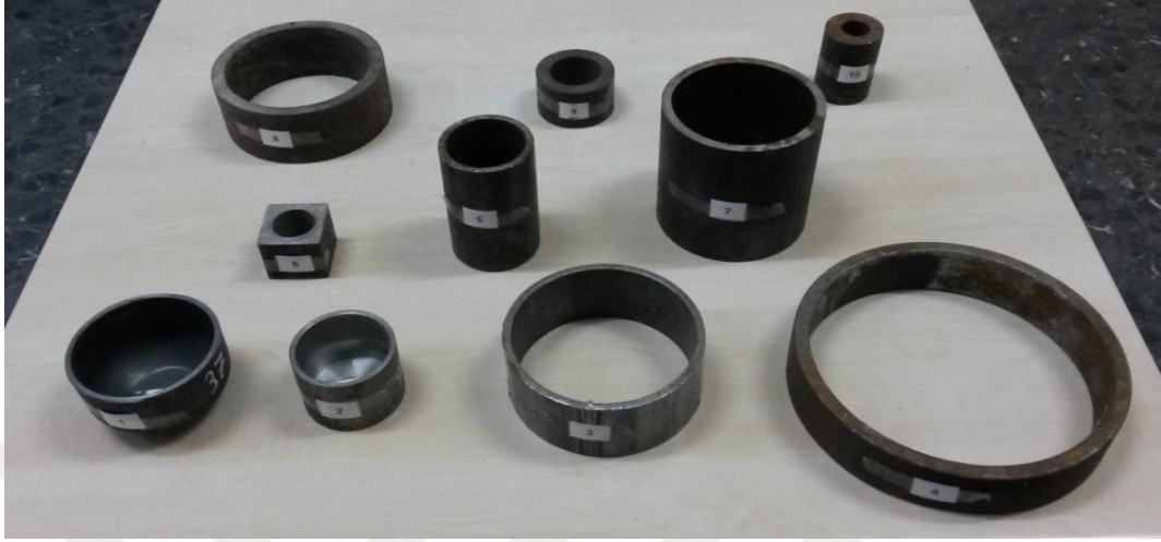
Şekil 4.2: EYP’lerde kap olarak kullanılabilecek numunelerin görüntüleri.
