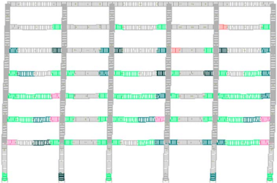
Şekil 4.49. 0.2g'ye göre ölçeklenen Kocaeli deprem kaydından elde edilen hasarlar
