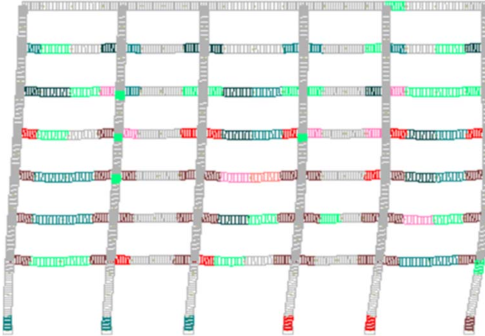
Şekil 4.51. 0.4g'ye göre ölçeklenen Kocaeli deprem kaydından elde edilen hasarlar
