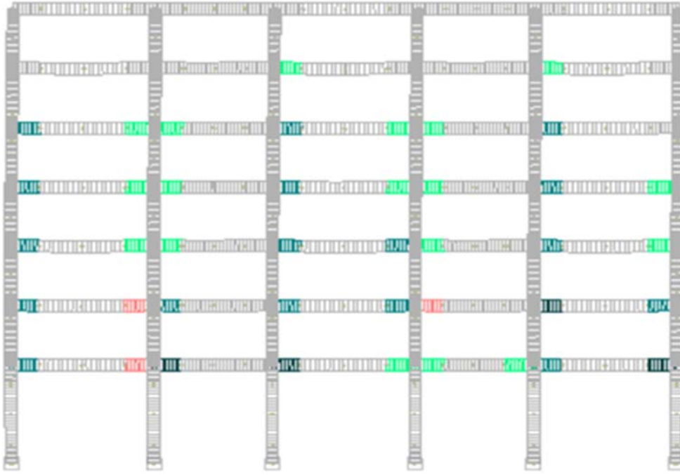
Şekil 4.43. 0.1 g'ye göre ölçeklenen Kobe deprem kaydından elde edilen hasarlar
