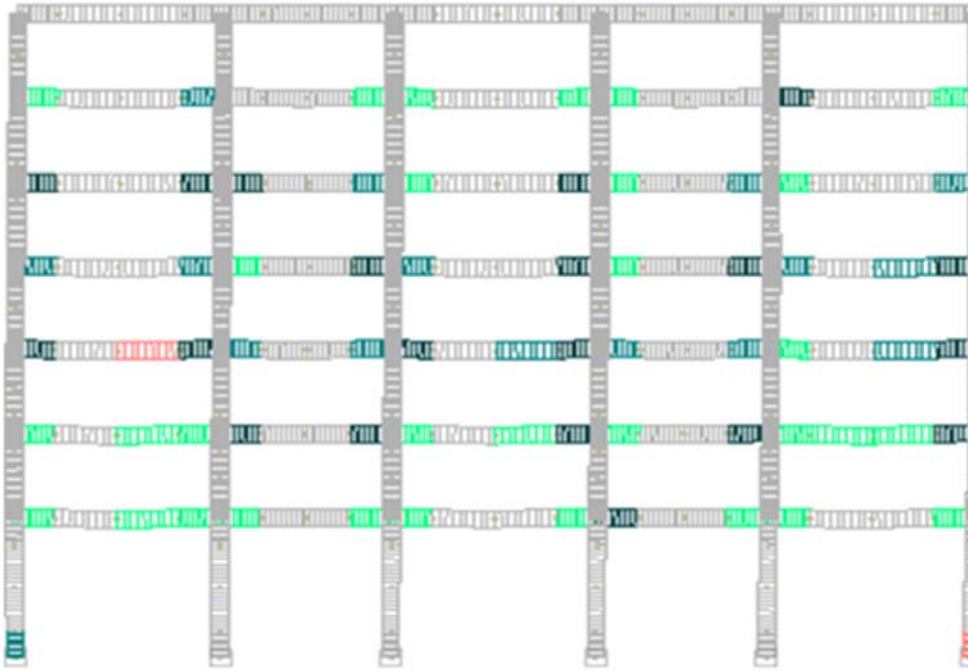
Şekil 4.44. 0.2g'ye göre ölçeklenen Kobe deprem kaydından elde edilen hasarlar
