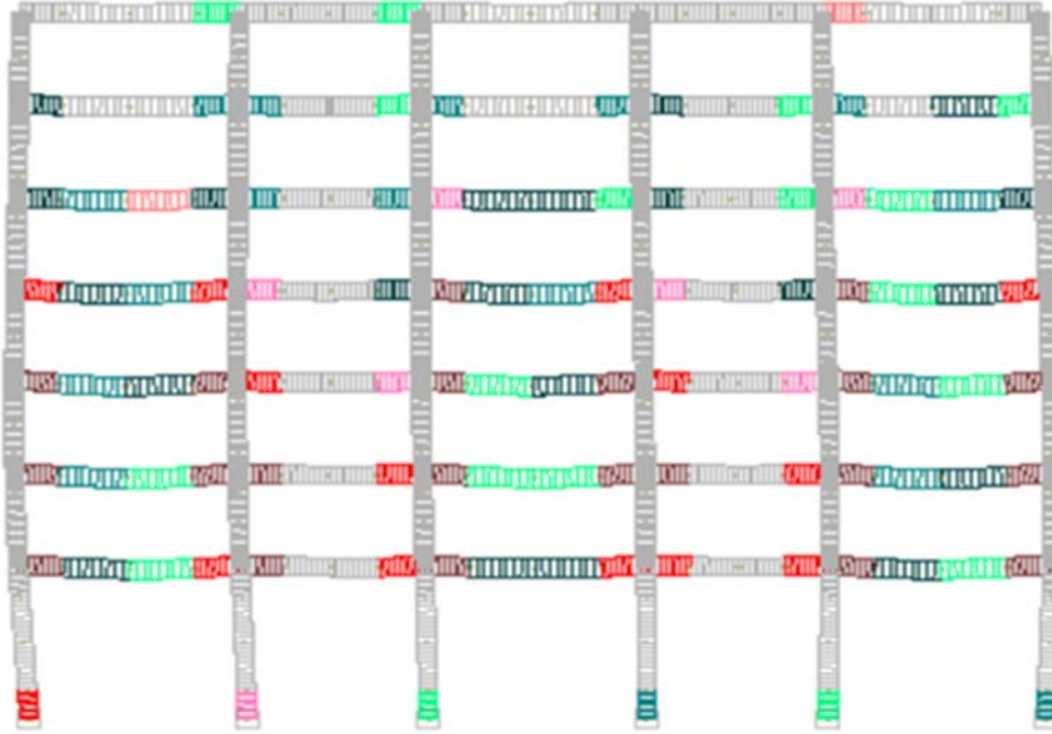
Şekil 4.41. 0.4 g'ye göre ölçeklenen Imperial Valley deprem kaydından elde edilen hasarlar
