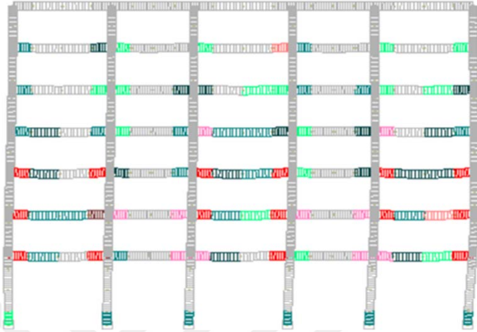
Şekil 4.45. 0.3g'ye göre ölçeklenen Kobe deprem kaydından elde edilen hasarlar
