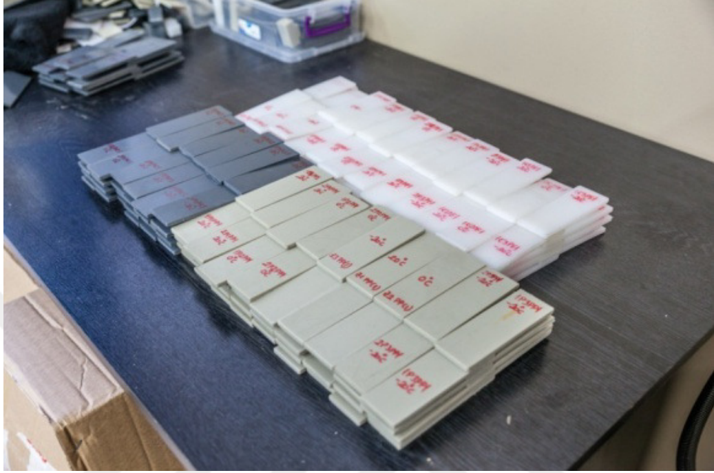
Şekil 4.6: Yapıştırılmış çekme deney numuneleri.
