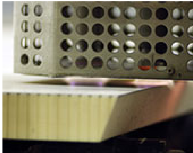
Şekil 2.10: Sandviç panel üzerinde plazma uygulaması.
