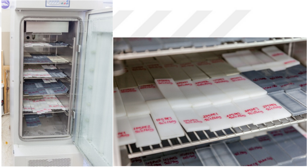
Şekil 4.8: İklimatik kabin içerisinde deney numunelerinin yaşlandırılması.
