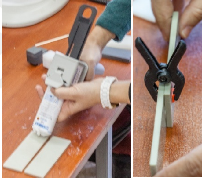
Şekil 4.7: Numunelerin yapıştırılma aşamaları.
