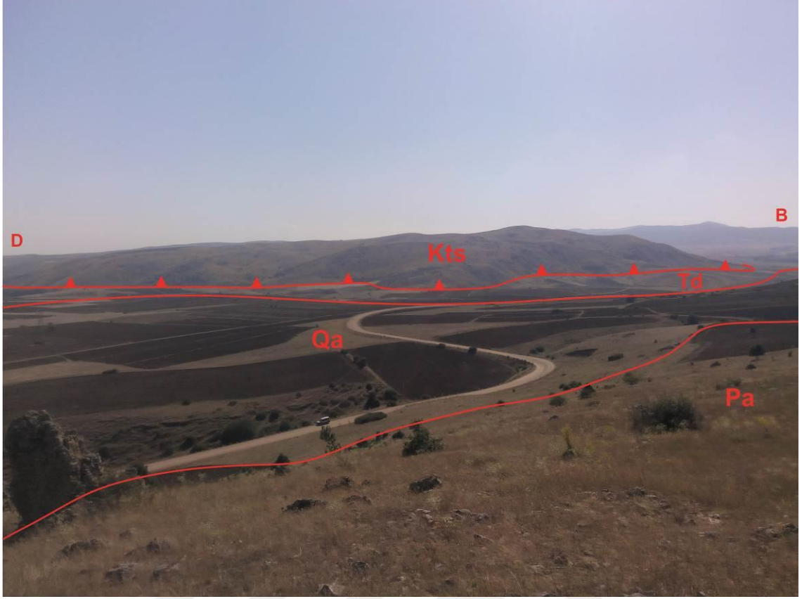
Şekil 2.7 Zengi kuzeyinde gözlenen ofiyolitli karışık ile volkanitlerin bindirme dokanağı ve kuvarsitlerin alüvyonlarla sınırının genel görünümü (İmamların ağılı civarında KD'dan GB'ya bakış). Kts: Serpantinit Td: Darmik volkanitleri Qa: Alüvyon Pa: Akdağmadeni Litodemi(Kuvarsit)
