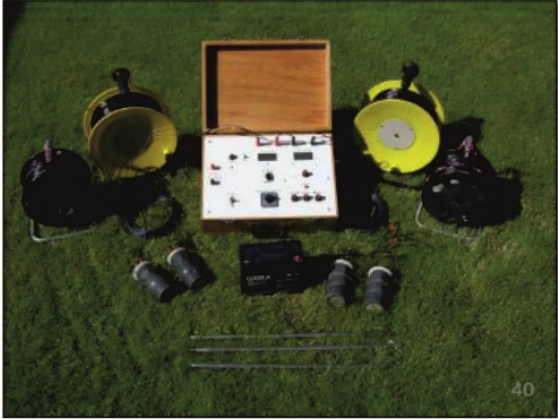
Şekil 3.30 Elektrik Öz direnç ölçüm aletleri (URL 6).
