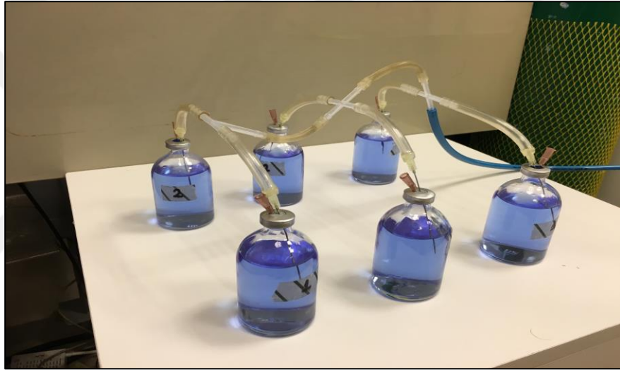
Şekil 3.2: Kesikli biyoreaktörlerin argon gazı ile oksijensizleştirilmesi.
