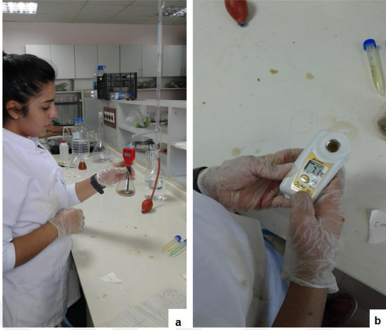
Şekil 3.9. Meyvede pH (a) ve SÇKM ( b) değerinin belirlenmesi
