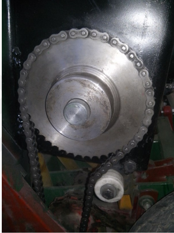
Şekil 4.2. Hareketi tekerden karıştırıcı kademe dişlisine aktaran dişli
