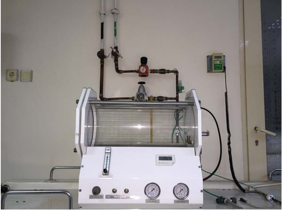
Şekil 4. Deney Basınç Odası
