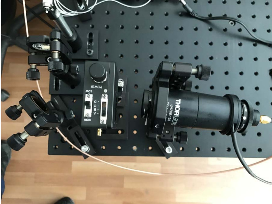
Şekil 3.3. FPI kurulumu ve ayarlanması
