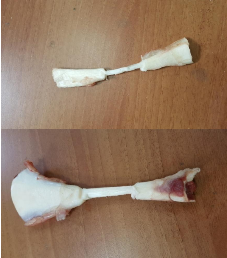
Şekil 5.4 Papyon yöntemi ile orta kısmı zayıflatılmış bovine tendonunun görüntüsü
