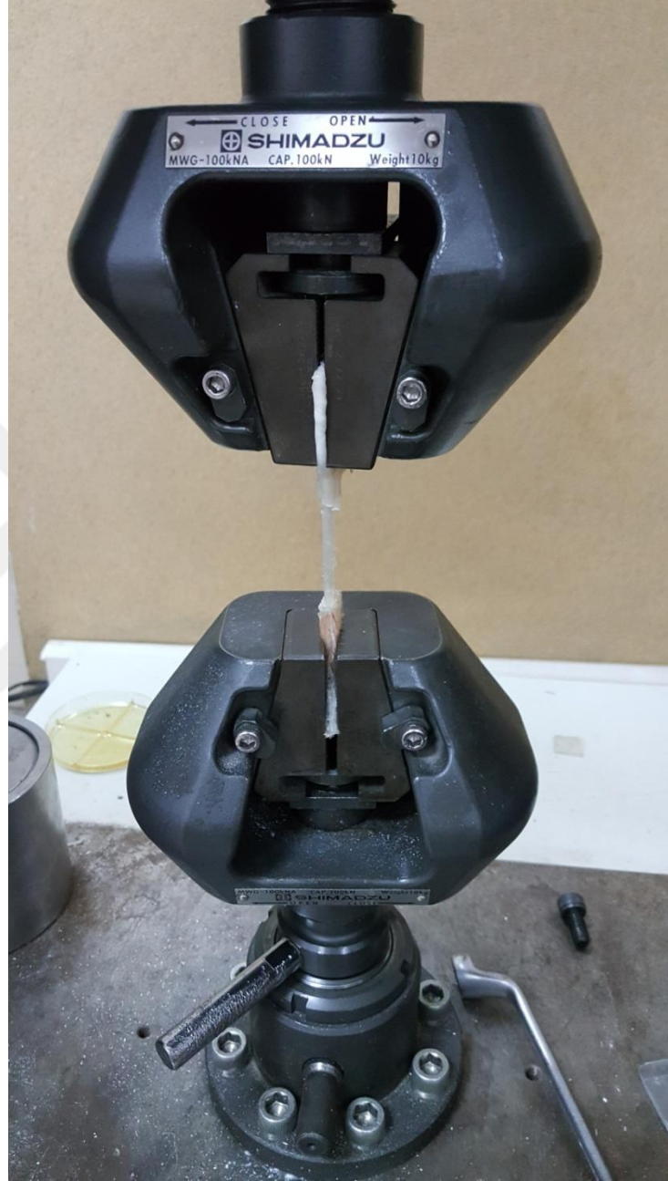
Şekil 5.5 Çekme cihazı yardımı ile eksenel yüklemeye maruz bırakılan tendon numunesi
