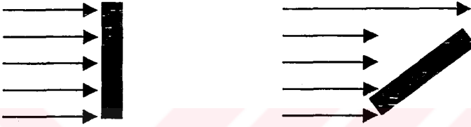
Şekil 5.5 : Gelen ışığın yönüne dik ve eğik yüzeyler. Gelen ışığın yönüne dik olarak yerleştirilmiş olan yüzey eğik olarak yerleştirilmiş aynı büyüklükteki bir yüzeye göre daha fazla ışık alır.
