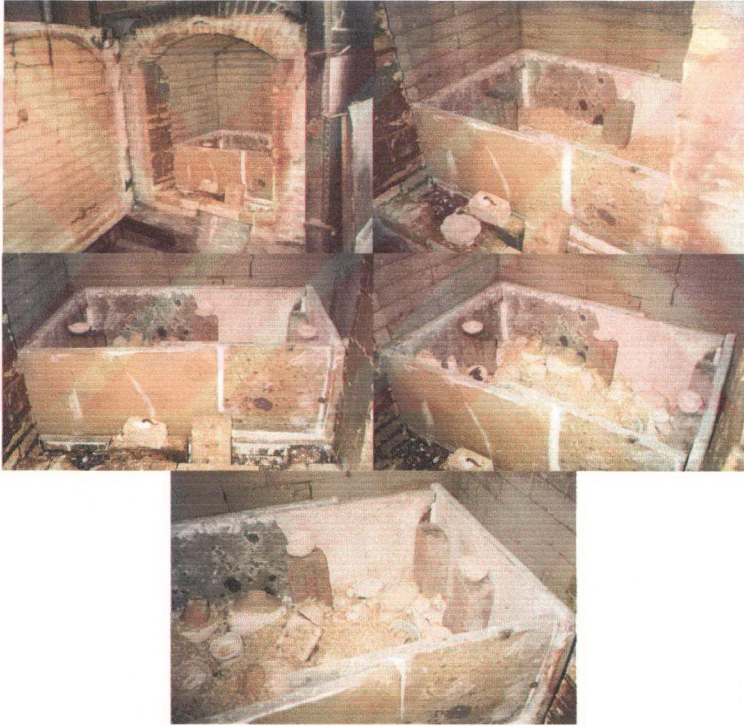
Resim 34 : Amerika Taccoma Community Collage'de Kullanılan Gazlı Fırın İçerisinde Refrakter Fırın Rafları ve Tuğlaları ile Oluşturulmuş Sagar Kutusunda Yapılan Sagar Pişirim Tekniği.
