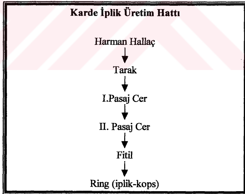
Şekil 2.1 Karde İplik Üretim Akış Şeması
