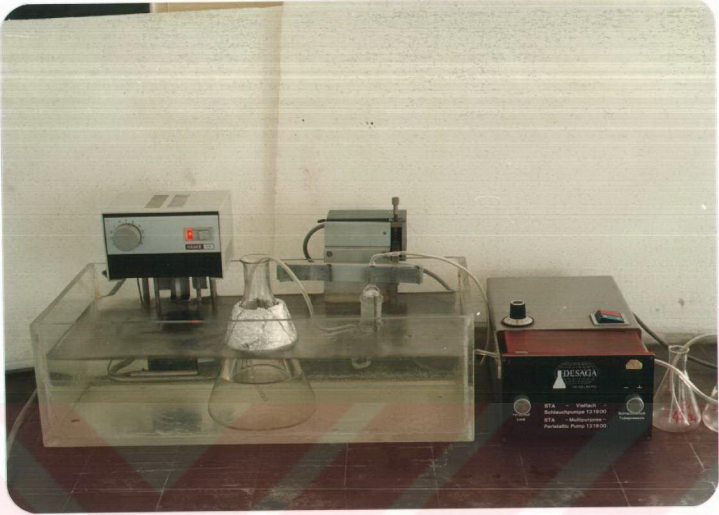
Resim II.3 Çözünme hızı tayininde kullanılan sürekli akış hücresi düzeneği
