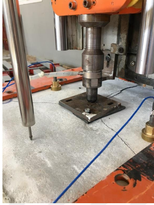
Şekil 7.23. P3-YS3 deney elemanında meydana gelen çatlaklar
