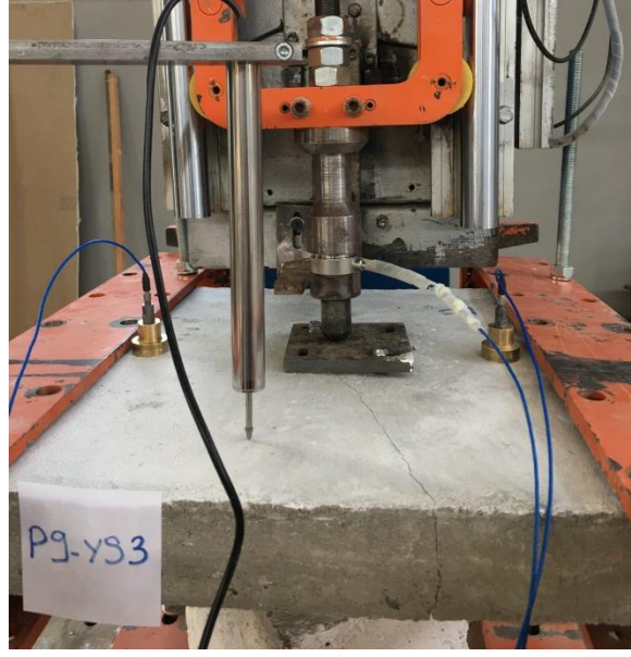
Şekil 7.83. P9-YS3 deney elemanında meydana gelen çatlaklar
