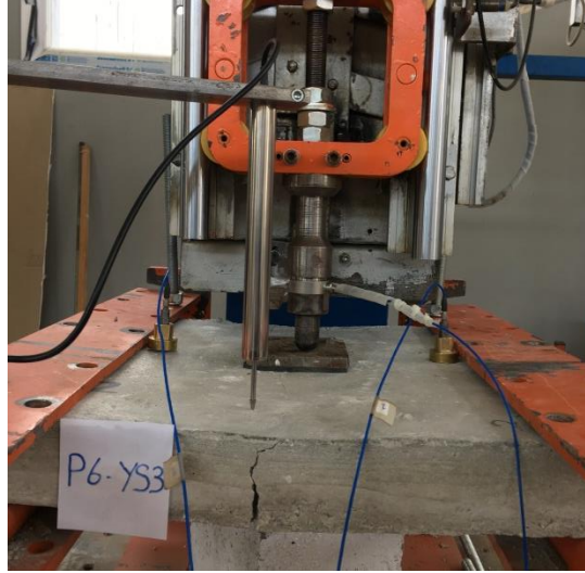
Şekil 7.53. P6-YS3 deney elemanında meydana gelen çatlaklar
