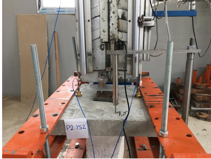
Şekil 7.12. P2-YS2 deney elemanı
