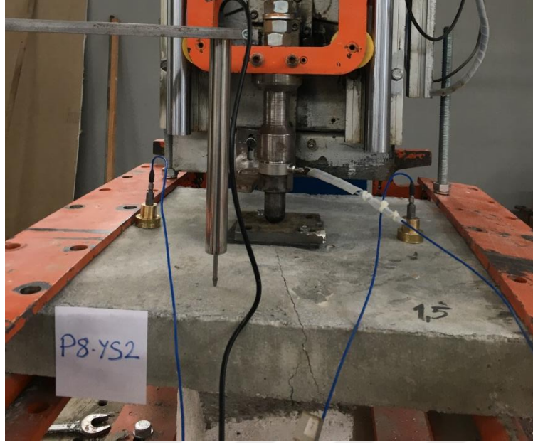
Şekil 7.73. P8-YS2 deney elemanında meydana gelen çatlaklar
