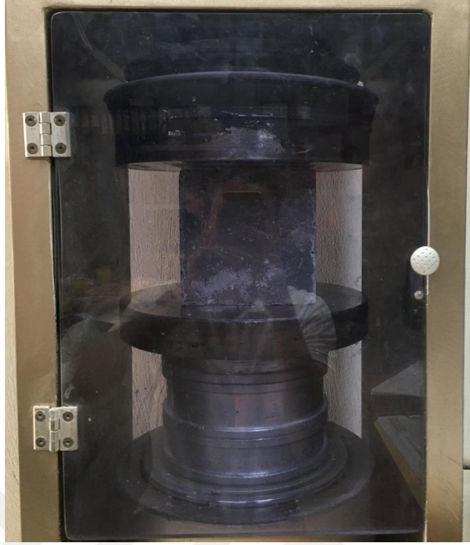
Şekil 6.2. Deney elemanlarının basınç dayanım değerlerinin belirlenmesi
