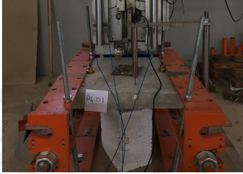
Şekil 7.32. P4-YS1 deney elemanında meydana gelen çatlaklar
