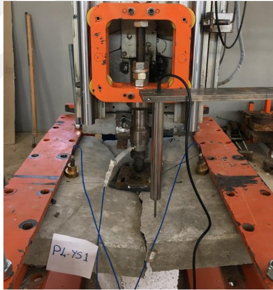
Şekil 7.34. P4-YS1 deney elemanında meydana gelen göçme hasar
