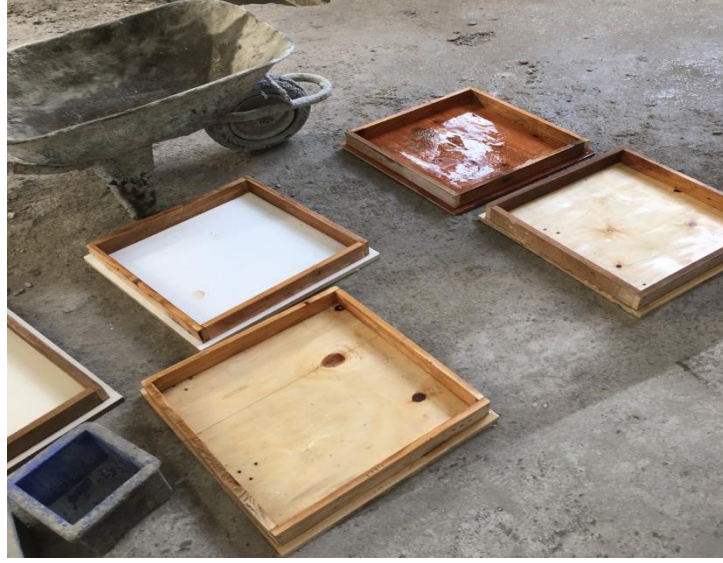
Şekil 6.3. Kalıp yağı ile yağlanmış kalıplar
