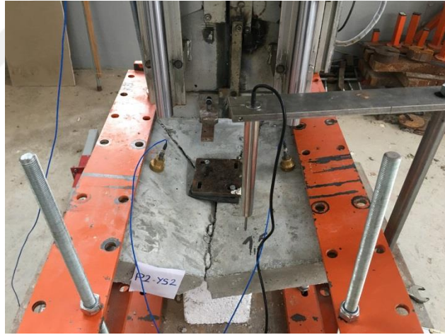
Şekil 7.14. P2-YS2 deney elemanında meydana gelen göçme hasar
