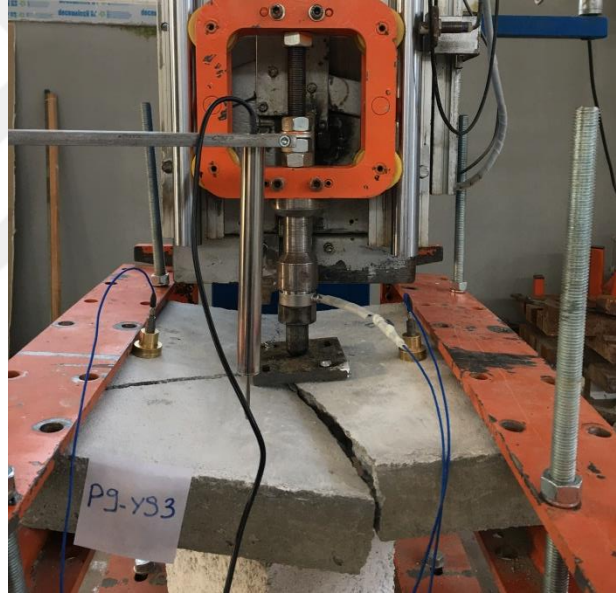
Şekil 7.84. P9-YS3 deney elemanında meydana gelen göçme hasar
