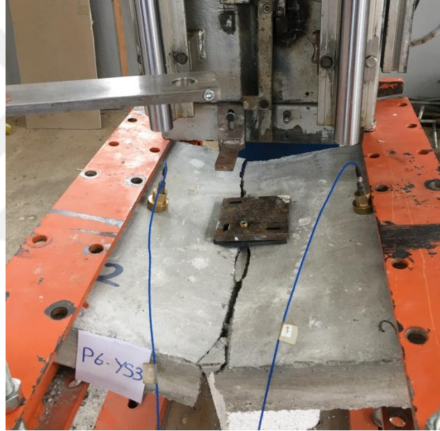
Şekil 7.54. P6-YS3 deney elemanında meydana gelen göçme hasar
