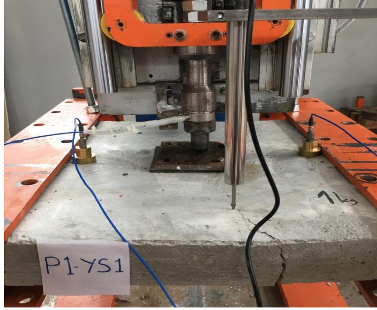
Şekil 7.3. P1-YS1 deney elemanında meydana gelen çatlaklar
