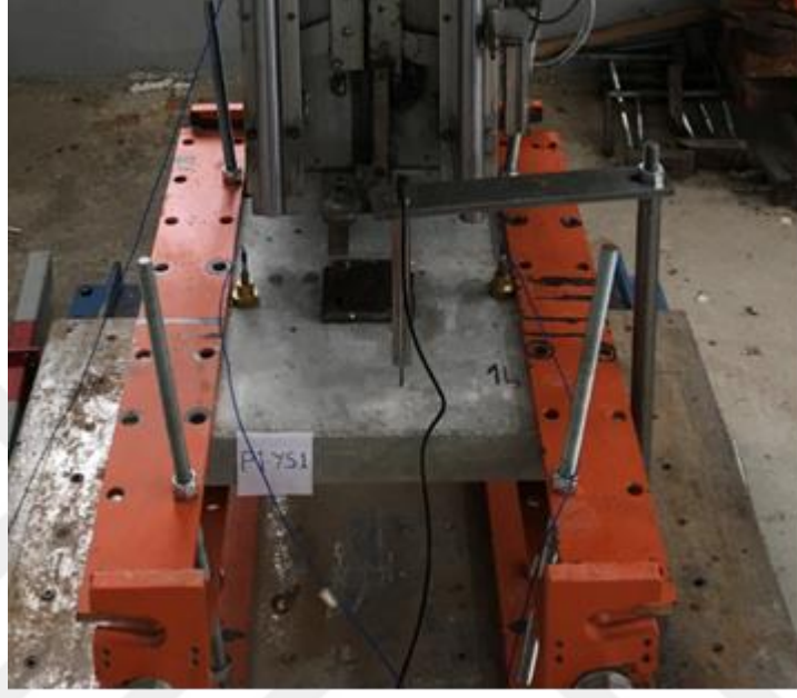
Şekil 7.2. P1-YS1 deney elemanı
