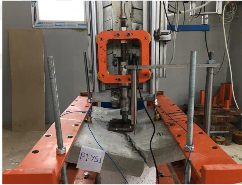
Şekil 7.4. P1-YS1 deney elemanında meydana gelen göçme hasar
