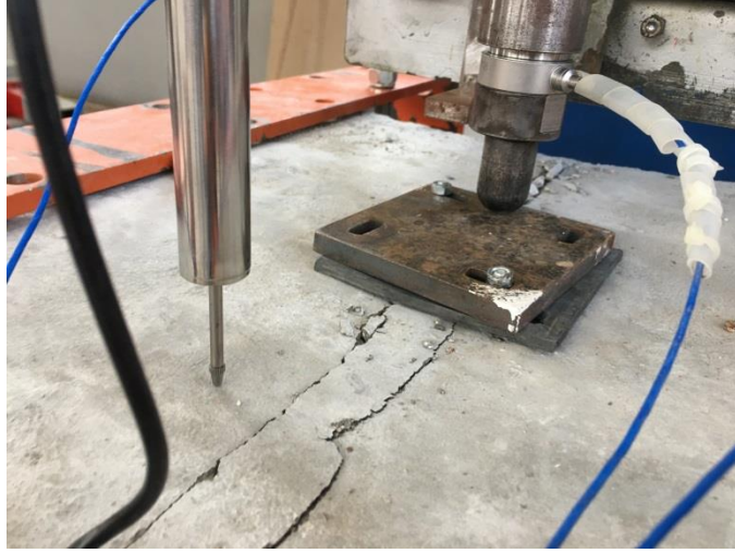
Şekil 7.63. P7-YS1 deney elemanında meydana gelen çatlaklar
