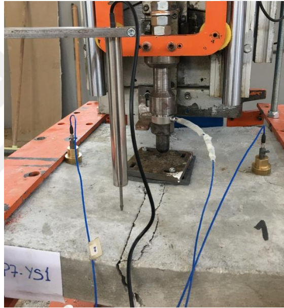
Şekil 7.64. P7-YS1 deney elemanında meydana gelen göçme hasar
