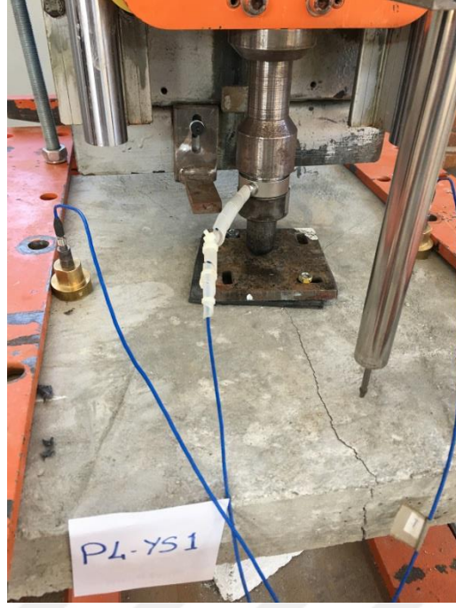
Şekil 7.33. P4-YS1 deney elemanında meydana gelen çatlaklar
