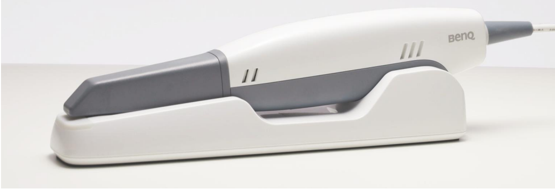
Şekil 4.9. BenQ BIS-1 ağız içi tarama cihazı
