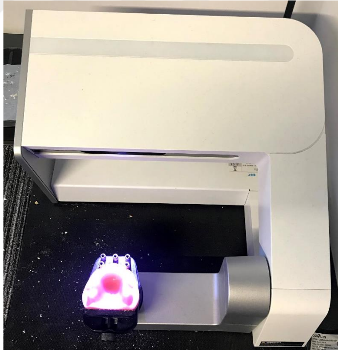
Şekil 5.4. Model tarama cihazı ile referans modellerin taranması
